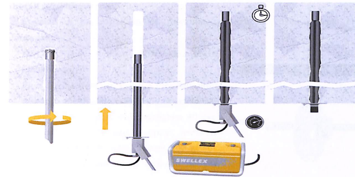
32. kép: SWELLEX kőzetcsavar manuális telepítése „kézi” erővel. Forrás: [9]
