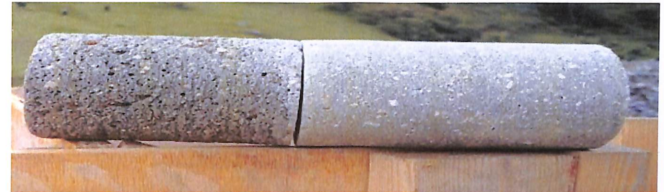
23. kép: Ugyanaz a beton, ugyanabból a keverékből, viszont más szórópisztoly kezelő által fellöve!
