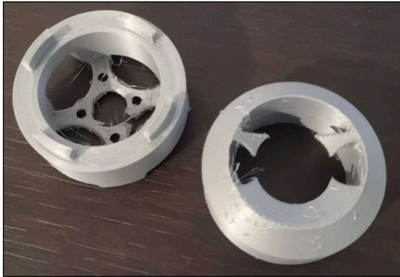
17.ábra: Motor rögzítésének első terve, 3D nyomtatva PLA-val
