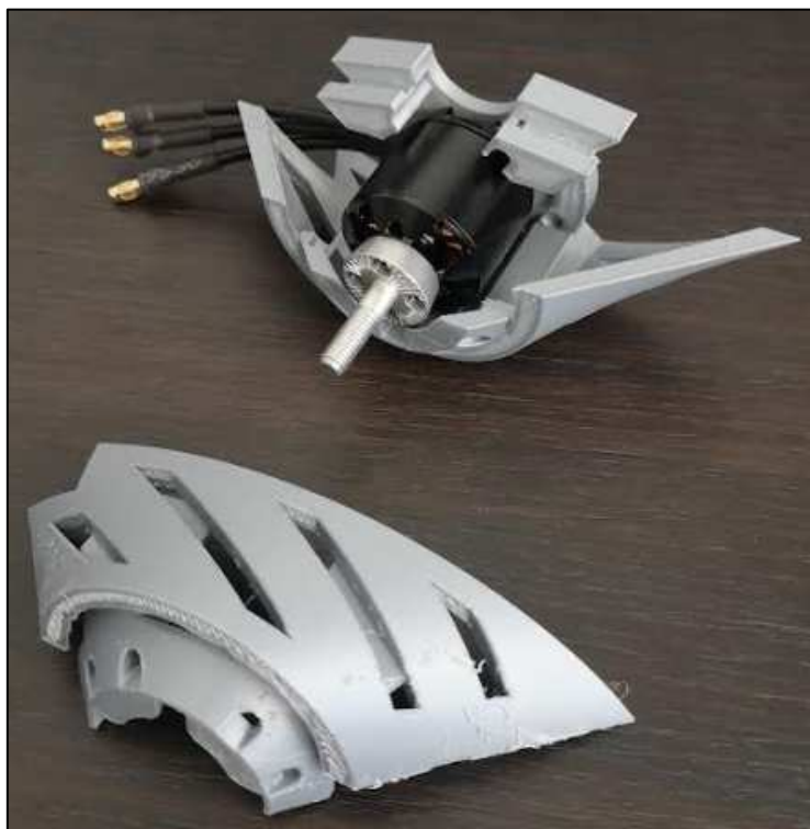
19.ábra: Motortartó szerkezet második verziója, 3D nyomtatva PLA-val
