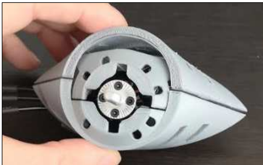
18.ábra: Motortartó szerkezet második verziója, 3D nyomtatva PLA-val
