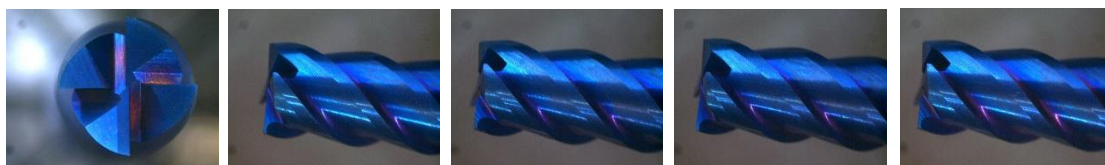
10. ábra. Nagyoló szerszám bemérés forgácsolás előtt
