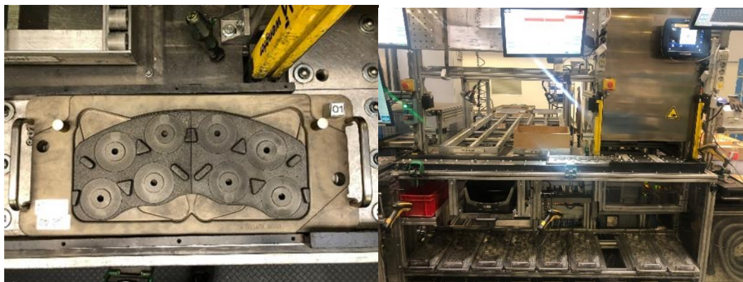
24. ábra Palettába helyezett hordozólemezek [8]
