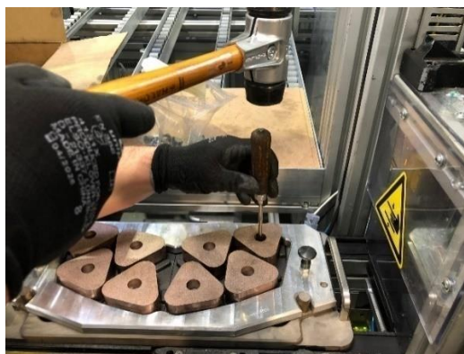
29. ábra Szegecsek helyükre ütése [8]
