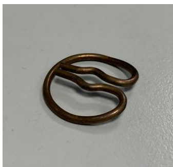
32. ábra Régi típusú biztosító rugó
