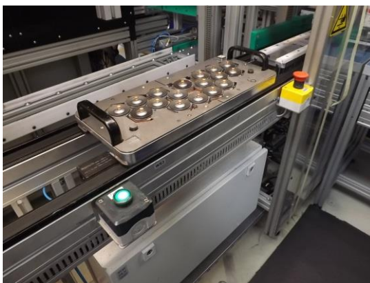
27. ábra Előszerelt paletta [8]
