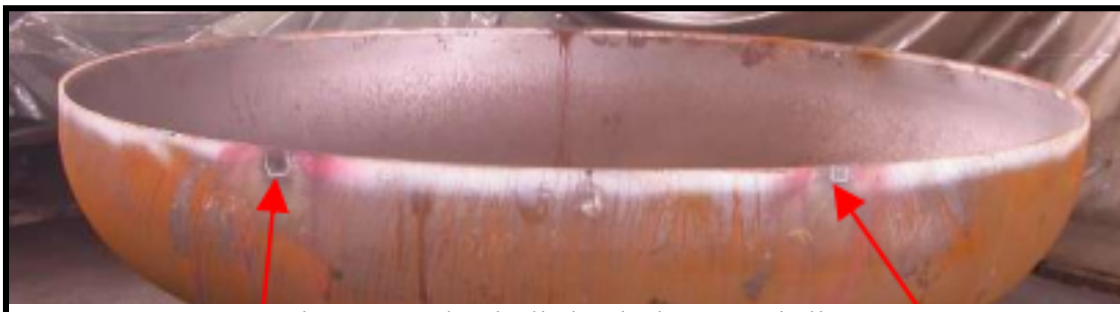
15. ábra A repedések elhelyezkedése a szakállrészen
