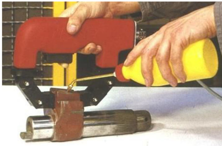
4. ábra Mágnesporos vizsgálat tengelyen [5]
