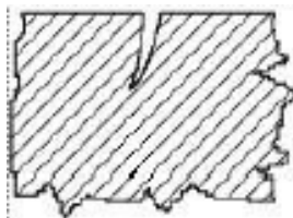
5. ábra Felületi hiba metszeti rajza [5]
