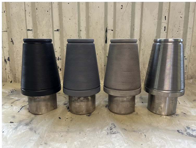
12. kép Csatlakozókúpok előkészítés alatti különböző állapotai
