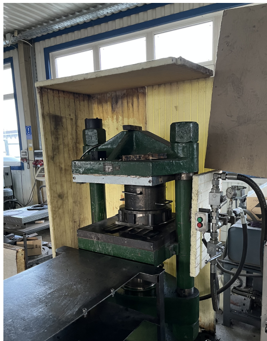
15. kép A kiválasztott gumivulkanizáló prés a behelyezett szerszámmal
