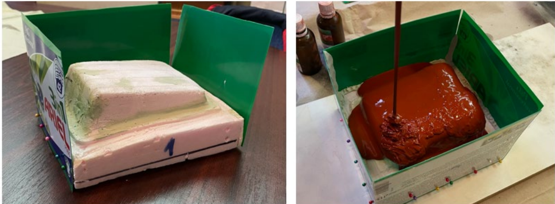
22. ábra A forma kijavítása és körbe falazása illetve a szilikon öntése
