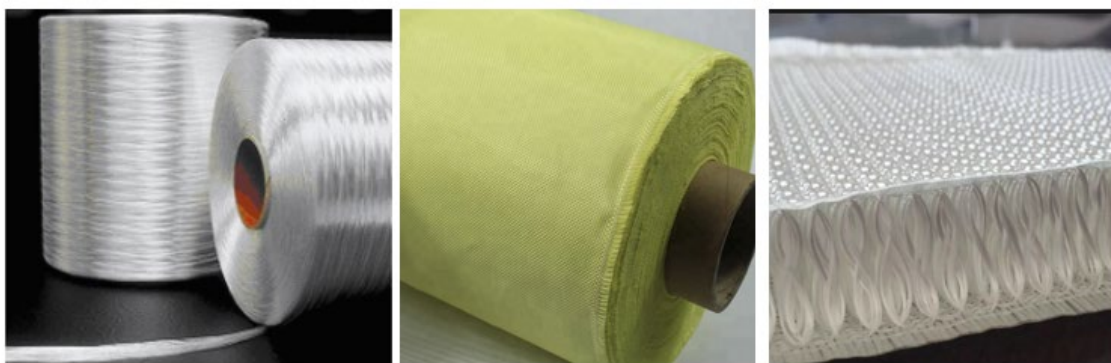
1. ábra Szálerősítő anyagok különféle formái, balról jobbra haladva: roving szál, szövött kelme, Parabeam 3D-s üvegszövet
