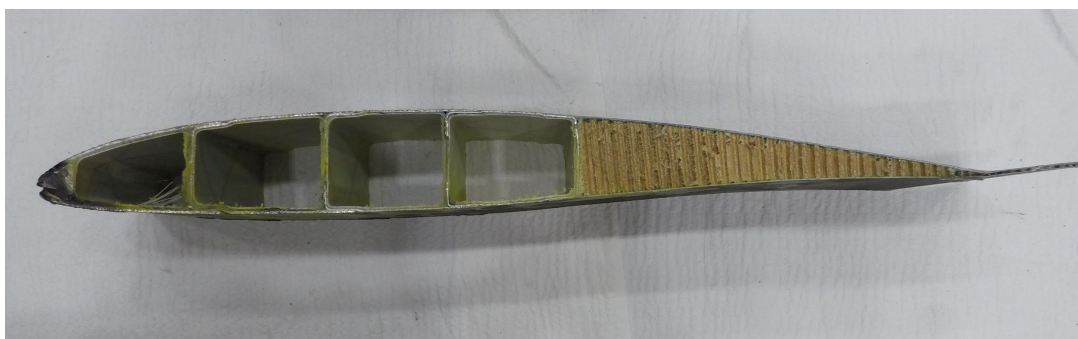
8. ábra A kikapó élnél látható sárga méhsejt szerkezet, a Nomex a merevséget szolgálja, de ezzel együtt rendkívül könnyű
