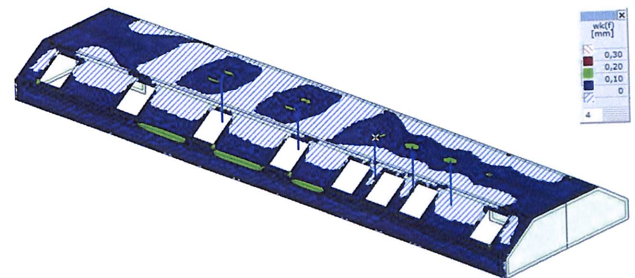
Felső repedéstágasság a betonacél tengelyvonalában
