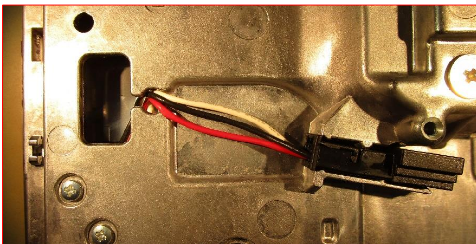
4. sz. melléklet: A sérült kábel helye az eszközön közelebbi nézetből
