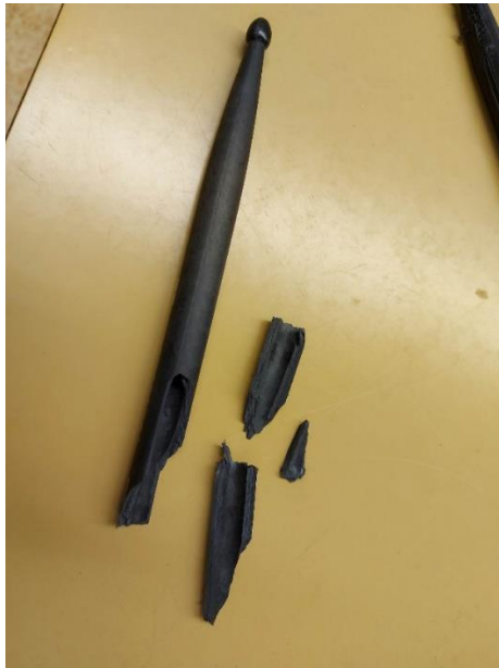
19. ábra Karbon szálak dobverő az ütővizsgálat után
