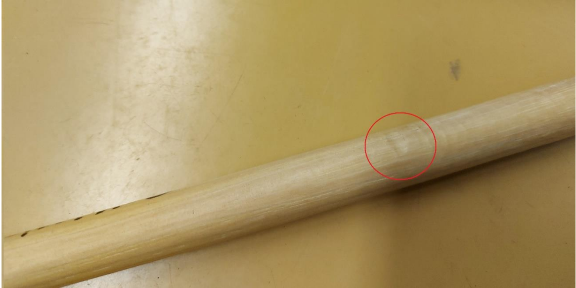
13. ábra Fa dobverőn látható felületi sérülés
