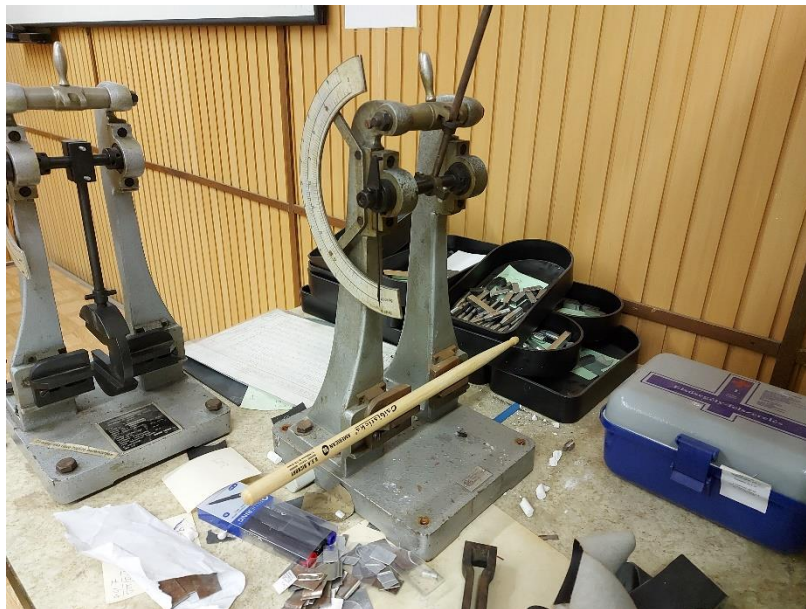
12. ábra Fa dobverő vizsgálata Charpy-féle ütőműn
