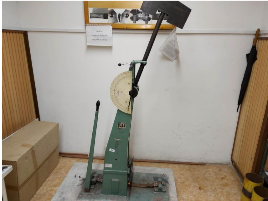
18. ábra Karbonszálak dobverő vizsgálata Charpy-féle ütőműn
