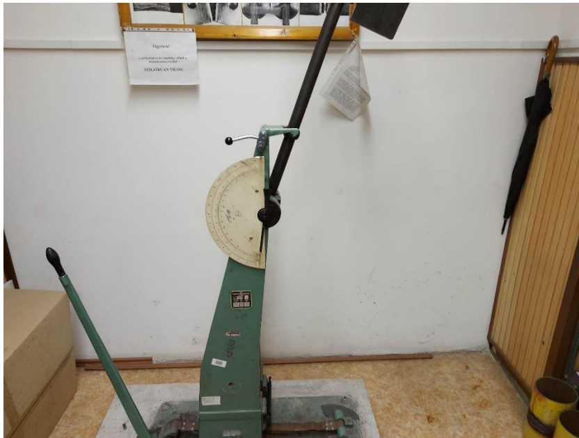
30. ábra 60%-os kitöltésű, szálirányú nyomtatással készült dobverő vizsgálata
