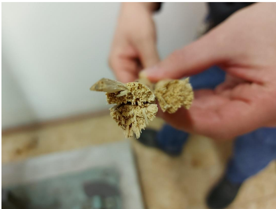
16. ábra American hickory dobverő belső textúrája törés után
