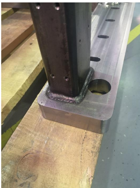
18. ábra Huzalelektrodás védőgázos ívhegesztéssel hegesztett sarokvarrat
