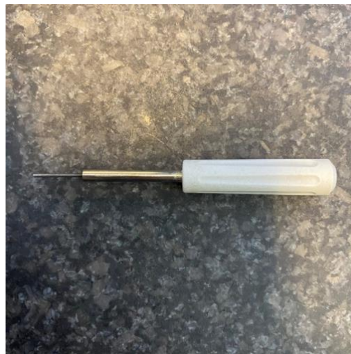
6. ábra: Mérőtű rögzítéséhez használat csavarhúzó
