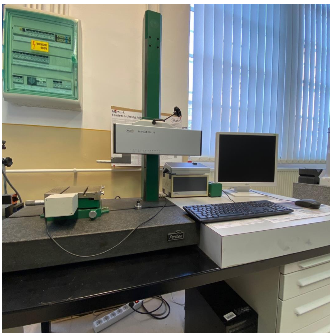
1. ábra: Felület érdességmérő mérőhely
