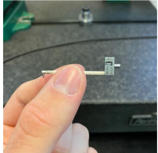
3. ábra: Mérőtű kézzel történő megfogása
