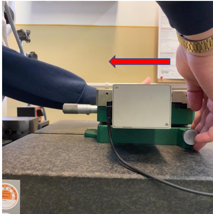
16. ábra: Alkatrészasztal mozgatásának módja
