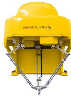
2.5. ábra: Fanuc M-1iA/1H delta robot [5]
