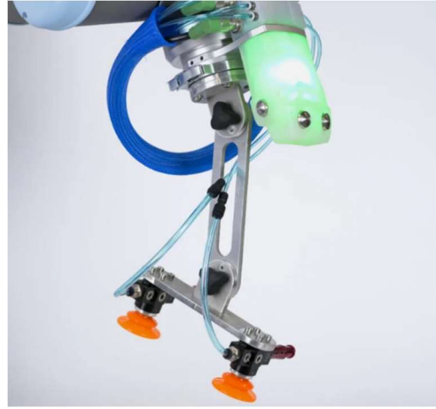
2.9. ábra: Példa vákuumos megfogóra [9]
