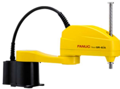
2.4. ábra: Fanuc SR-6iA Scara robot [5]
