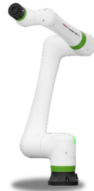
2.6. ábra: Fanuc CRX-20iA/L kollaboratív robot [5]
