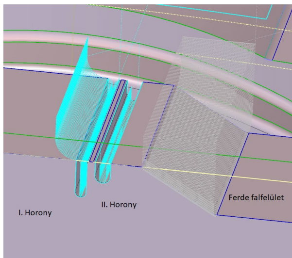
51. ábra, Hornyok, és a ferde falfelület szerszámpályái [saját kép]
