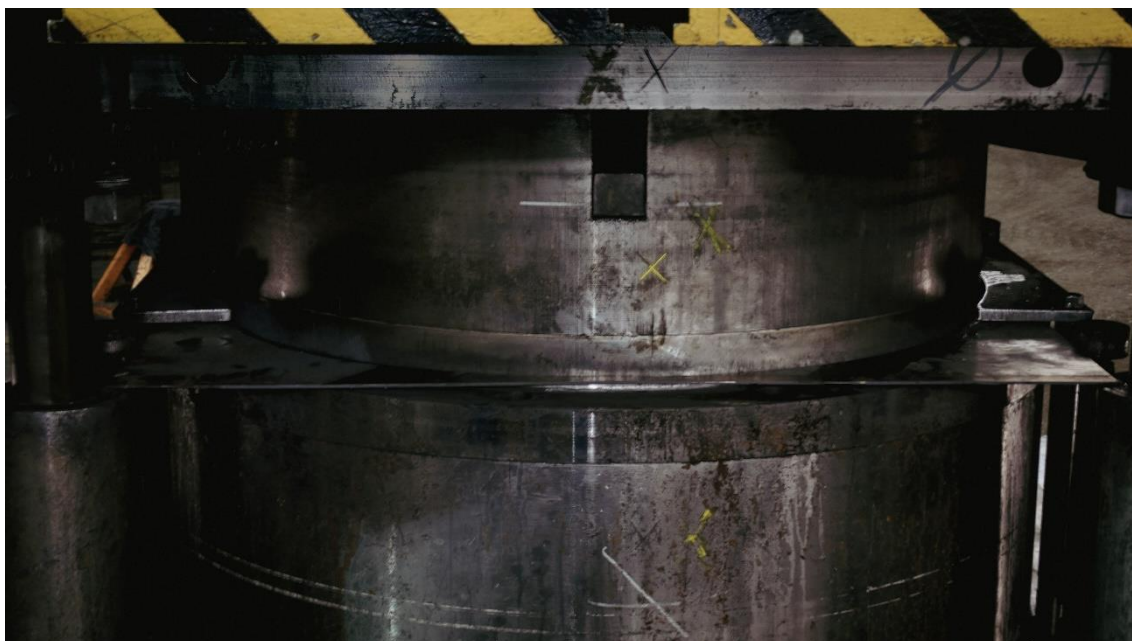
A felsőrész alsó végállás felé mozdulása során megtörténik a kivágás művelet.
