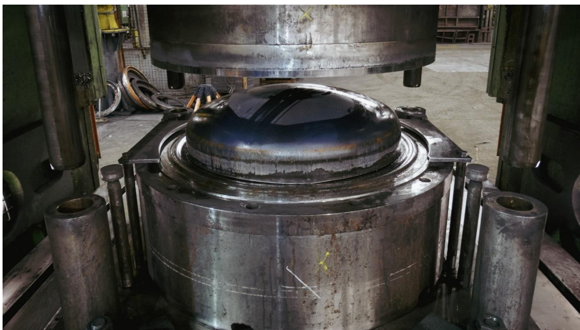
A húzás művelet végeztével, a hidraulikus párna a kiindulási helyzetbe mozgatja a ráncfogó gyűrűt és vele kiemeli a terméket.
