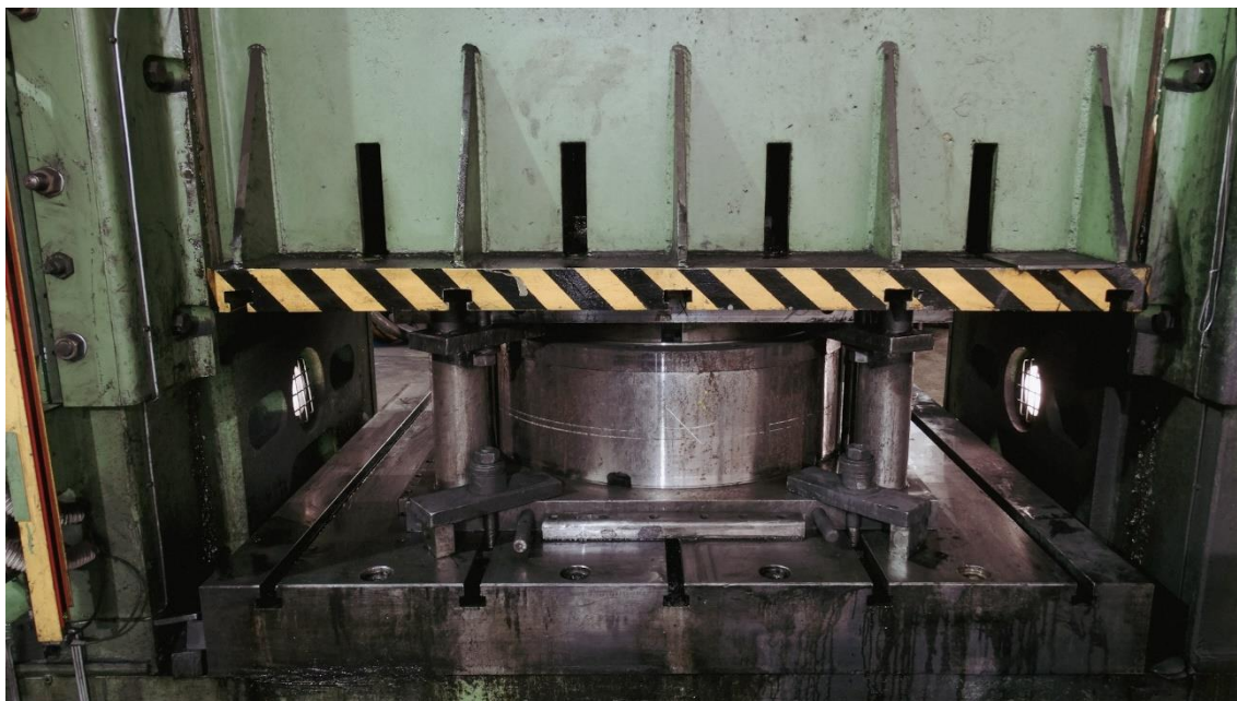
A blokkszerszám rögzítése a tárgyasztalhoz és a medvéhez csavaros rögzítőkkal.
