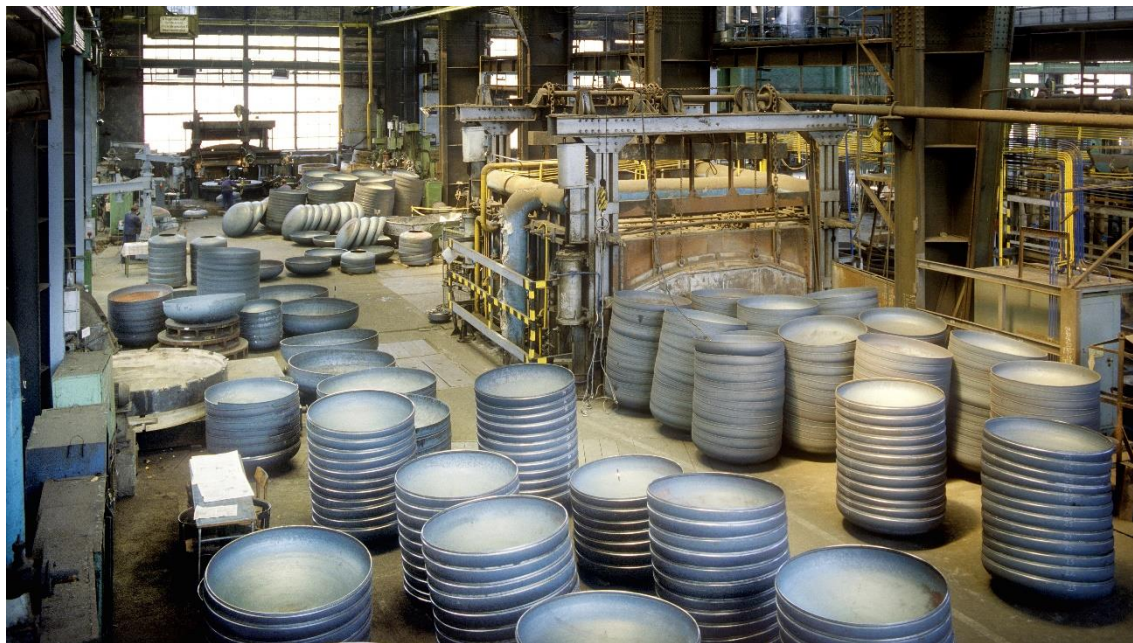
6. ábra Edényfenekek csomagolás előtt az üzemcsarnokban
