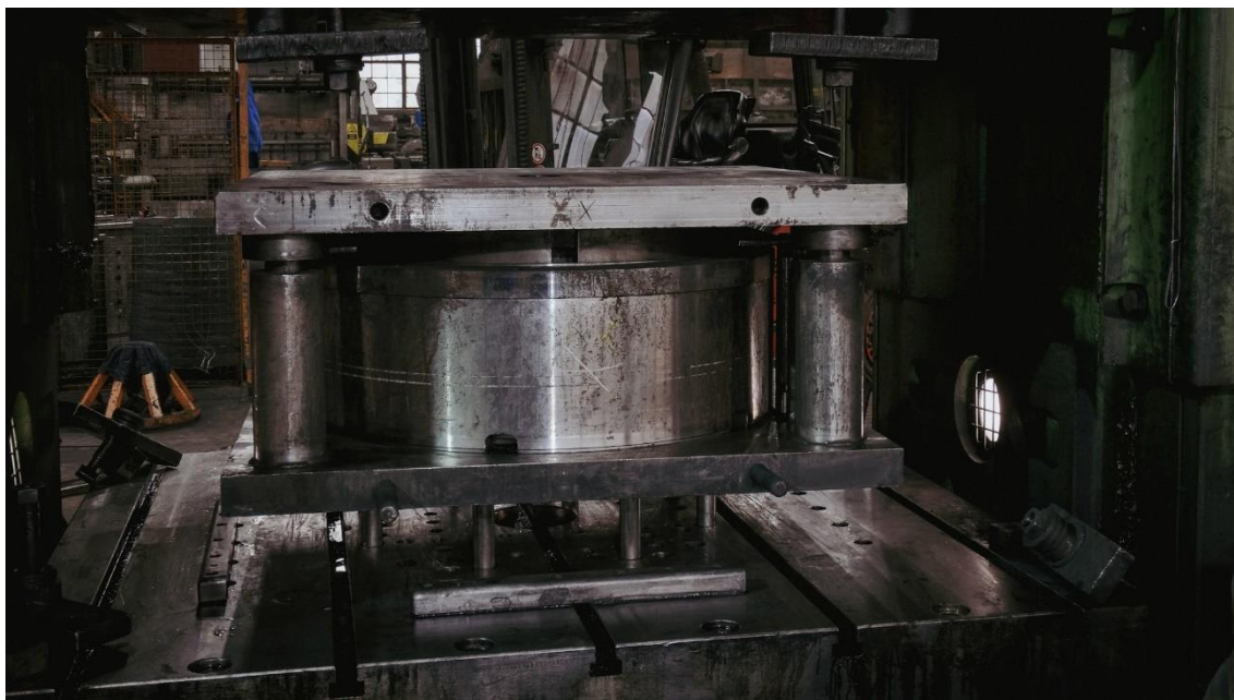
A szerszám pozíciója helytelen, ezért a húzópárna a kitolórudakkal elemeli a tárgyasztalról.
