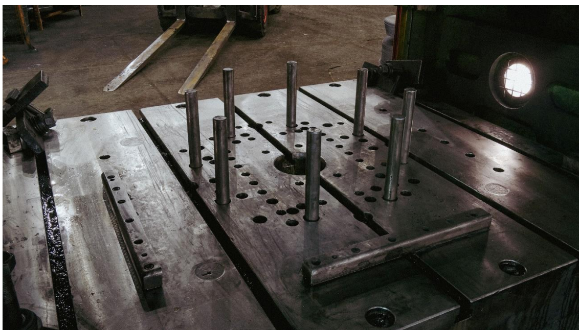
Kitolórudak behelyezése a megfelelő osztókörbe
