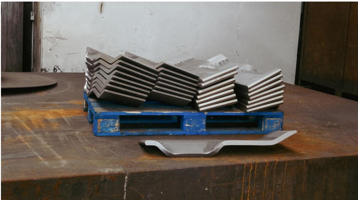
11. ábra Alaplap (Vasúti kocsik alvázánál használt alkatrész)
