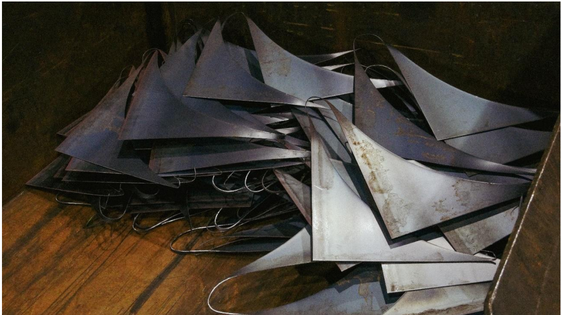
23. ábra Összehajtott vágási hulladék.
