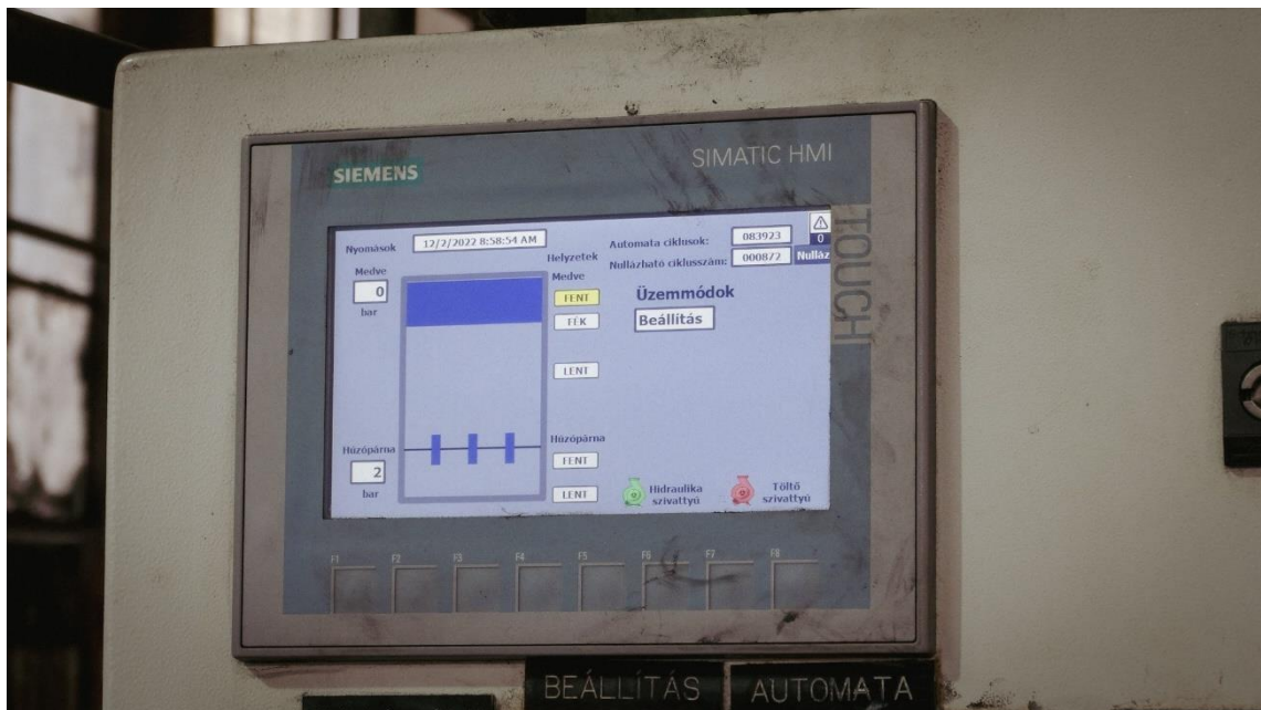
A húzópárna felső állásban van, amely megemeli a kitolórudakat ez látható a kijelzőn.
