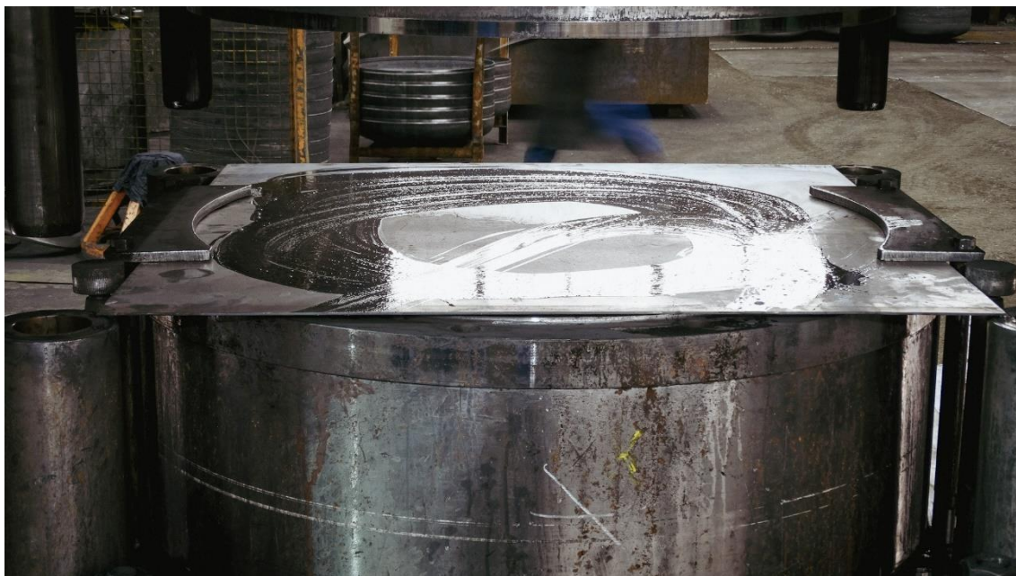
A blokkszerszámba helyezett teríték lemez kivágás és húzás előtt.
