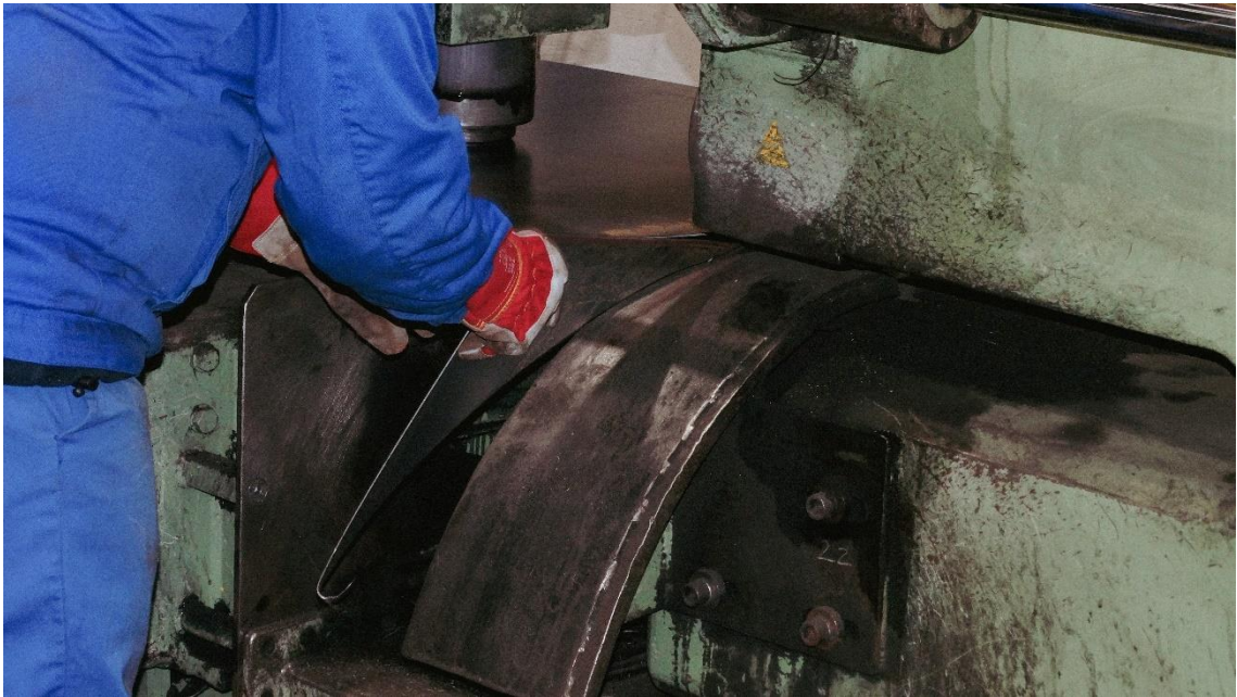
22. ábra Hulladék összehajtása és elvétele a körrollózási művelet során.
