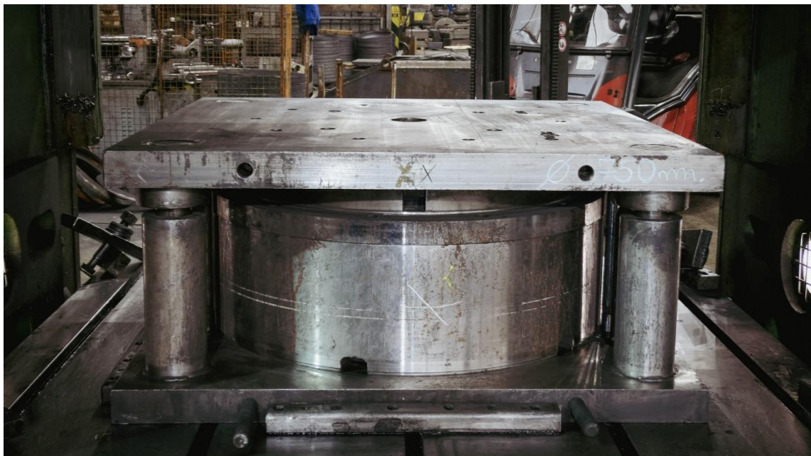
A behelyezett blokkzszerű illeszkedik a tájolólemezekhez.
