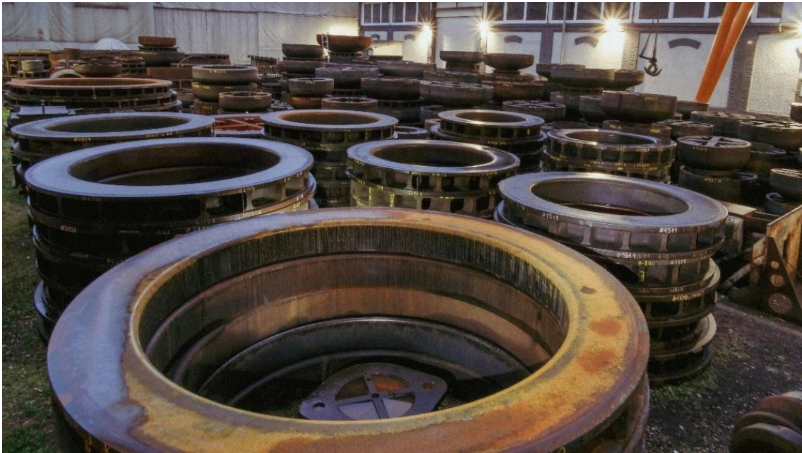
24. ábra Húzógyűrűk a külső szerszám térben.
