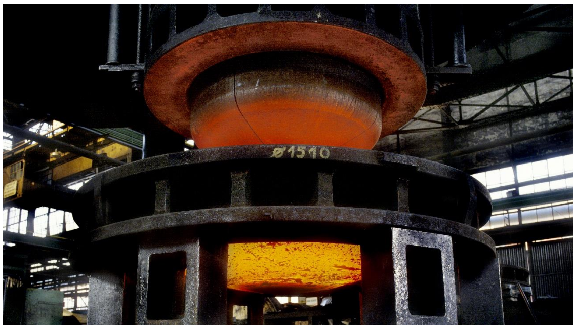
13. ábra Meleghúzás a 2000 tonnás présgépen
