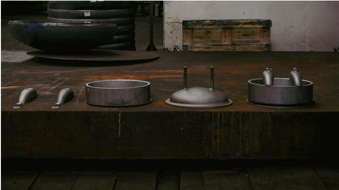
10. ábra Tartályokba építhető búvónyílás (Technokov Kft. által készített alkatrészei: Kengyelek, Oválgyűrű, Fedél, mellettük pedig az összeállított búvónyílás)
