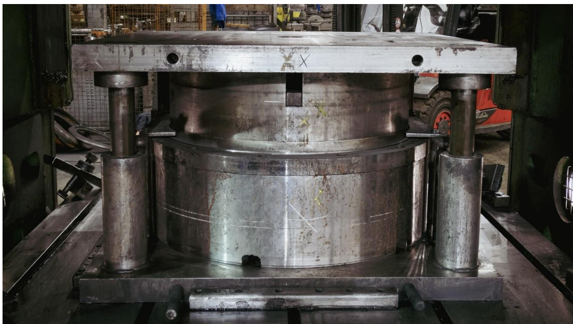
A szerszám helyzete megfelelő, a kitolórudak az alsórész csapjaiba illeszkednek a ráncfogógyűrű emelésével elemelik a felsőrészt.
