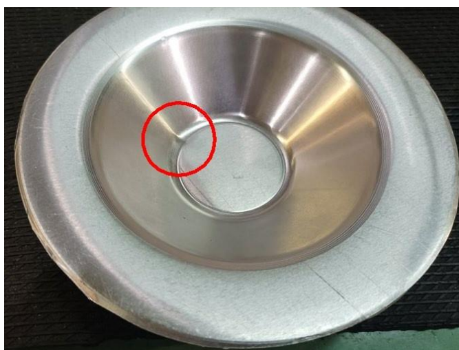
22. ábra Matlab szerszámpályaival alakított munkadarab
