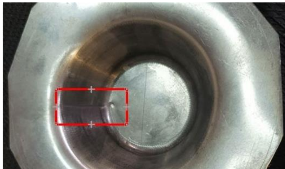
17. ábra Z-level okozta lenyomat
