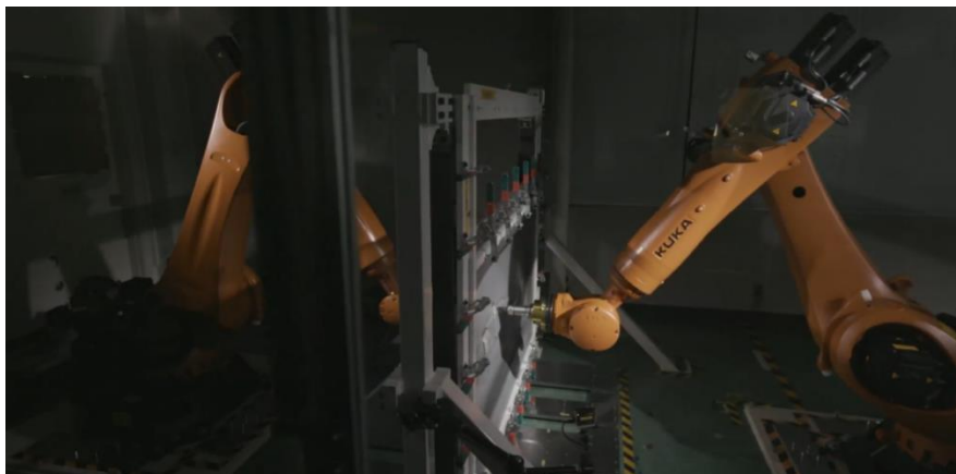
8. ábra Nissan után gyártott autó alkatrészek gyártása egy pontos inkrementális lemez alakítás ellenbéllyeges változatával
