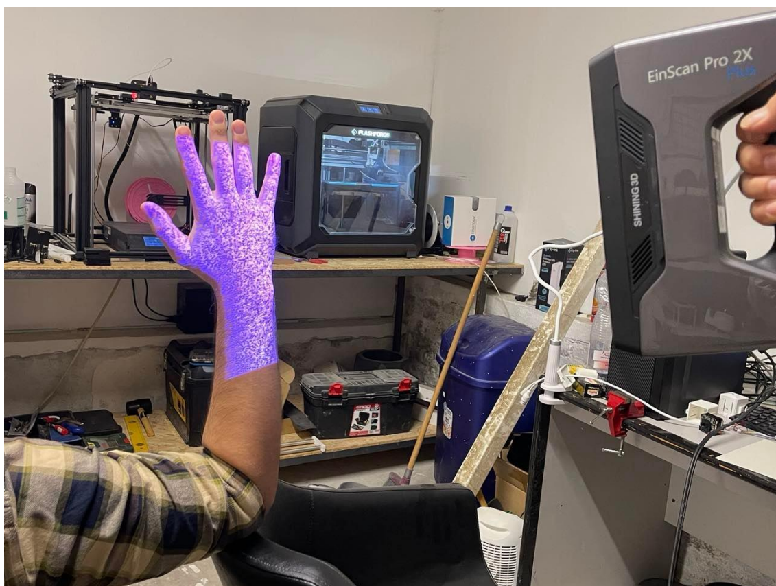
14. ábra. A jobbkez 3D szkennelése EinScan Pro 2X 3D szkennelőrrel
