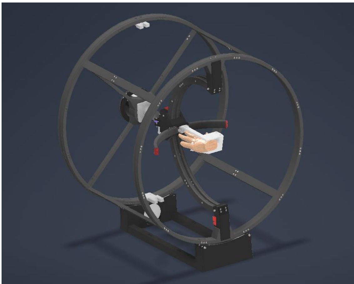
20. ábra. A rehabilitációs gép terve
