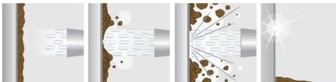
46. ábra. Szárazjeges tisztítási folyamat [30]
