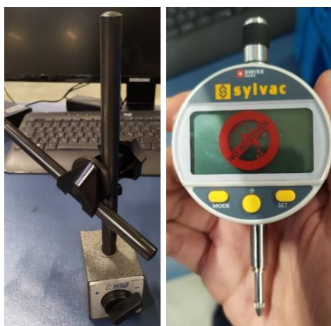
62. ábra. Mérőóraállvány és mérőóra a szereldébe
