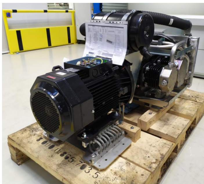
29. ábra. VV270-T kompresszor kísérőlappal funkciótesztre várva
