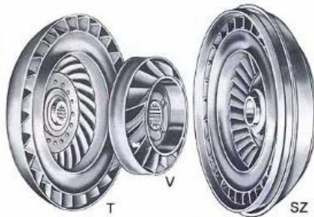
11. ábra: A hidrodinamikus nyomatékváltó munkakerekei [43]
