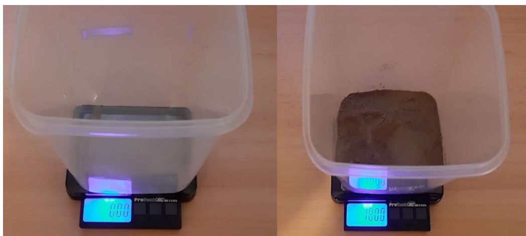
53. ábra. A mérőedény üres és mintával teli állapotban.
