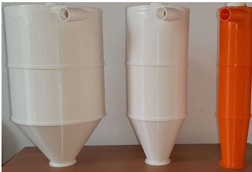
55. ábra. Az elkészült ciklonok teljes testmagasságú összeállítása.
