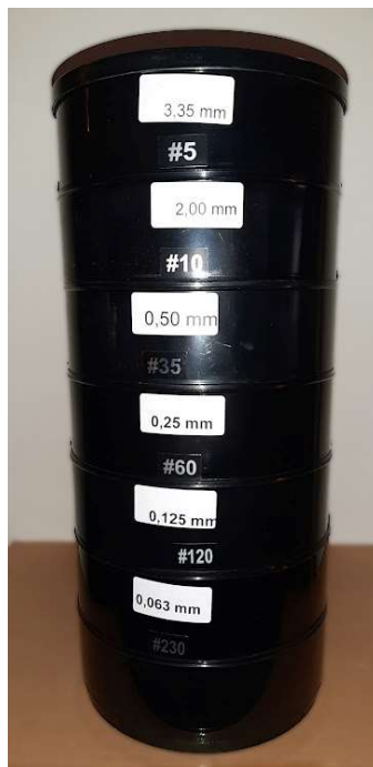
48. ábra. Windaus Labortechnik II-es szitakészlet
