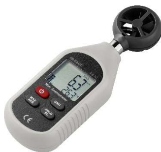
47. ábra. VOLTcraft AN-10 típusú anemometer [11]
