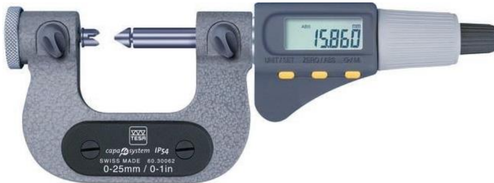
13. ábra Menetmérésre alkalmas digitális kijelzővel rendelkező mikrométer [16]
