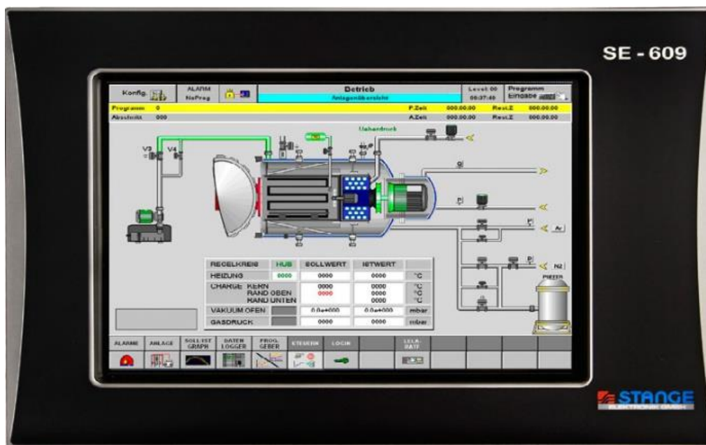
16.ábra A vákuumkemence Stange vezérlője
