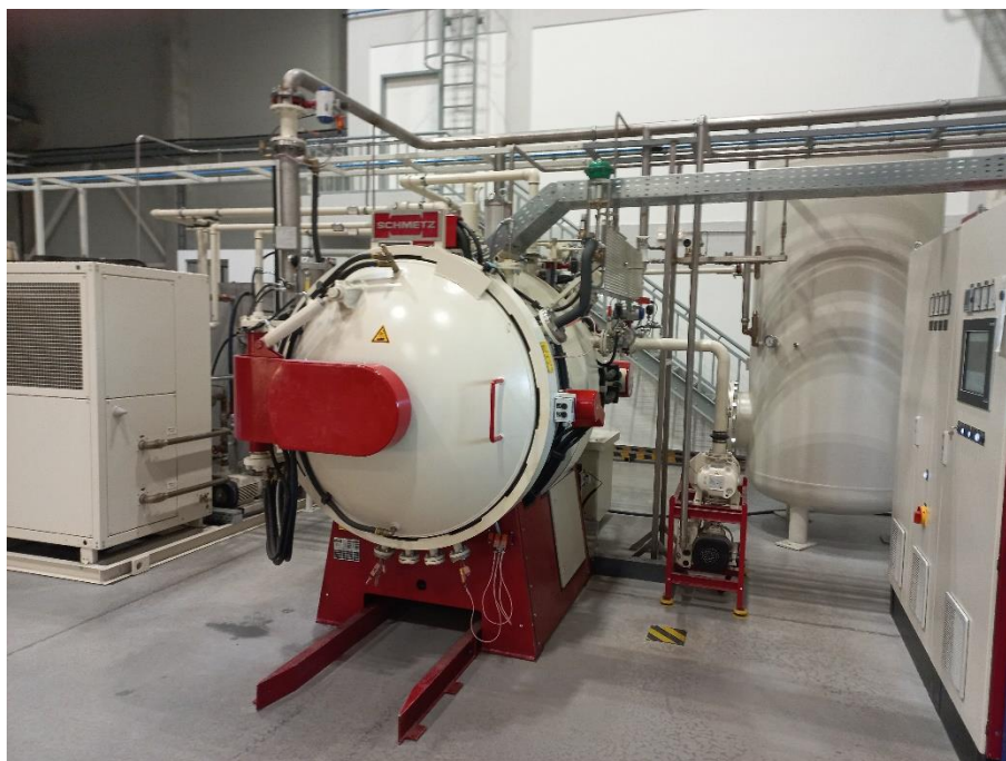
15.ábra Schmetz vákuum hőkezelő kemence
