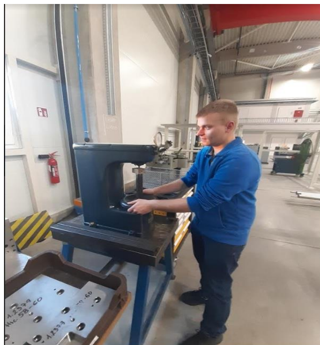
18.ábra A hőkezelte próbatest keménységmérése
