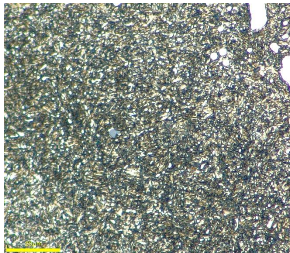
22.b. Optimálisan hőkezelt acél szövetszerkezete
