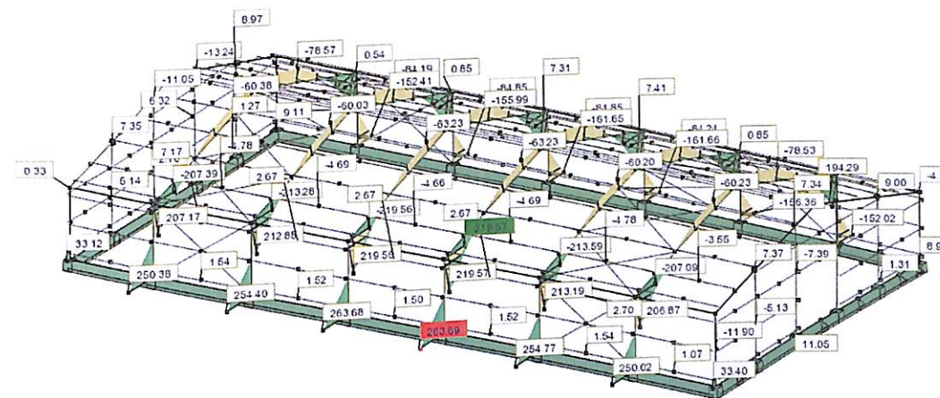
12. ábra: Szélcsatornás elemzés ( M_y ), M_{y,max} : +263,69 kNm, M_{y,min} : -219,57 kNm
