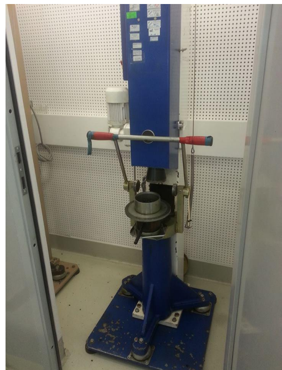
8. ábra Marshall döngölő
