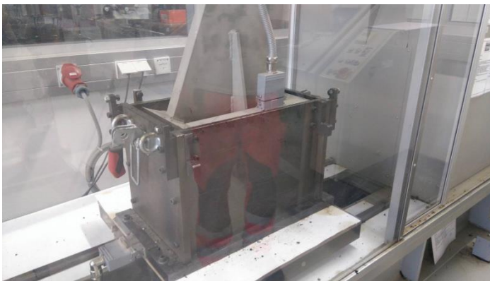
10. ábra Acélhengeres tömörítő
