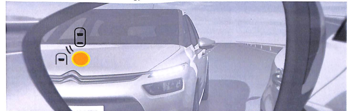
8. Kép Holttér figyelő rendszer működése
