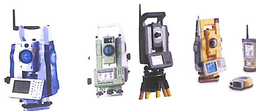
11. ábra - Sokkia, Leica, Trimble és Topcon robot-mérőállomások
