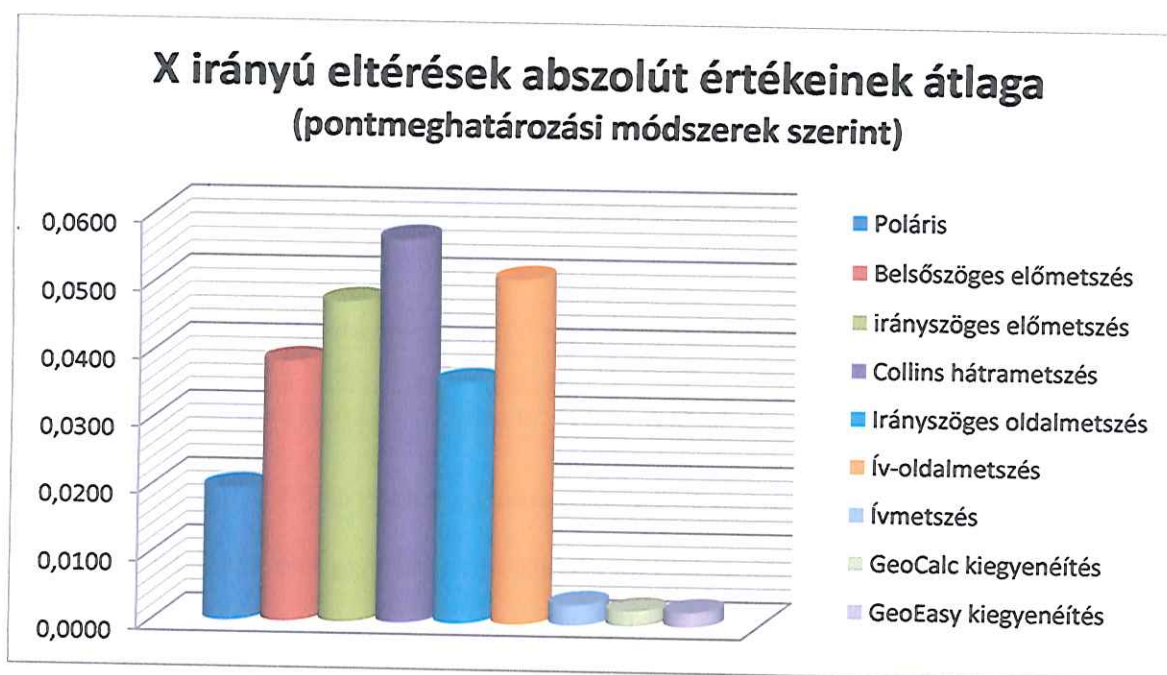
7.5. ábra X irányú eltérések abszolút értékeinek átlaga
