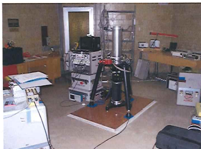
2.7. ábra Axis abszolút graviméter a budapesti abszolút ponton
