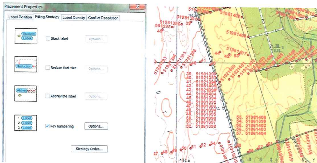
3.4. ábra. Illesztési beállítások (balra) sorszámozás megvalósítása (jobbra) (Forrás: MOL Görgeteg 3D projekt)
