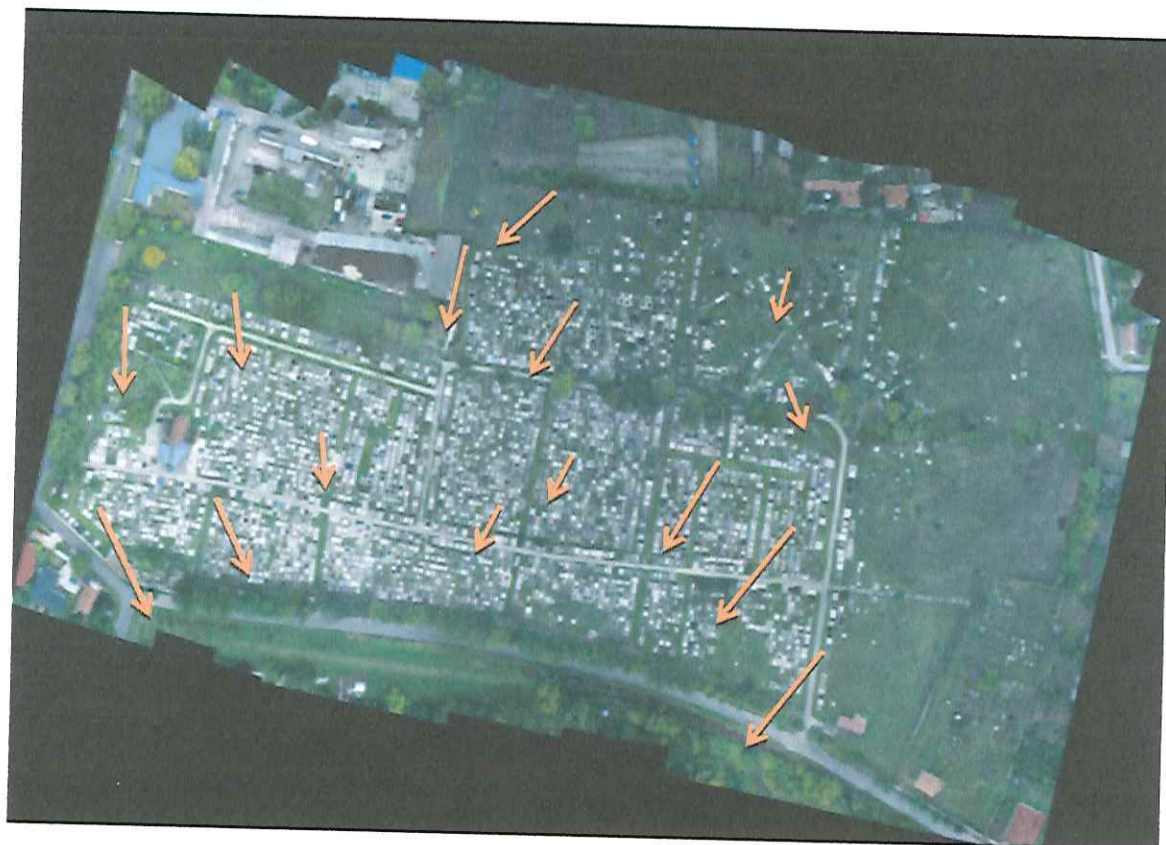
8.9. ábra Az ortofotó X irányú eltolódásának szemléltetése
