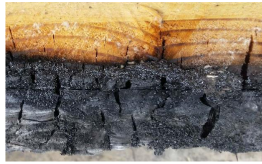
6. ábra: CLT panel tűzteszt utáni vizsgálata hőre nem-leváló ragasztó esetén, forrás: ARUP [2024]
