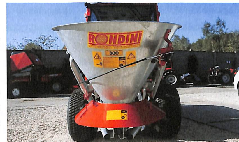
32. kép: Kőkúpos sósószóró adapter síkosságmentesítéshez fotó: sportpalyafenntartas.hu
