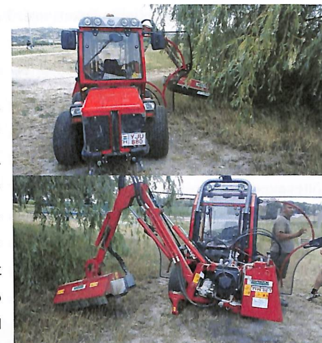
25. kép: Antonio Carraro munkagép részsűkasza adapterrel fotó: MK Zrt.
