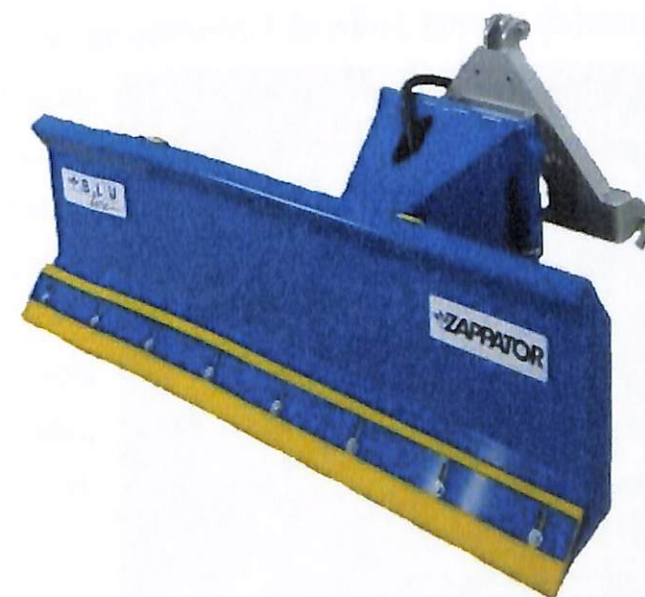
33. kép: Antonio Carraro munkagépre szerelhető Zappator típusú hóeke fotó: zappator.com
