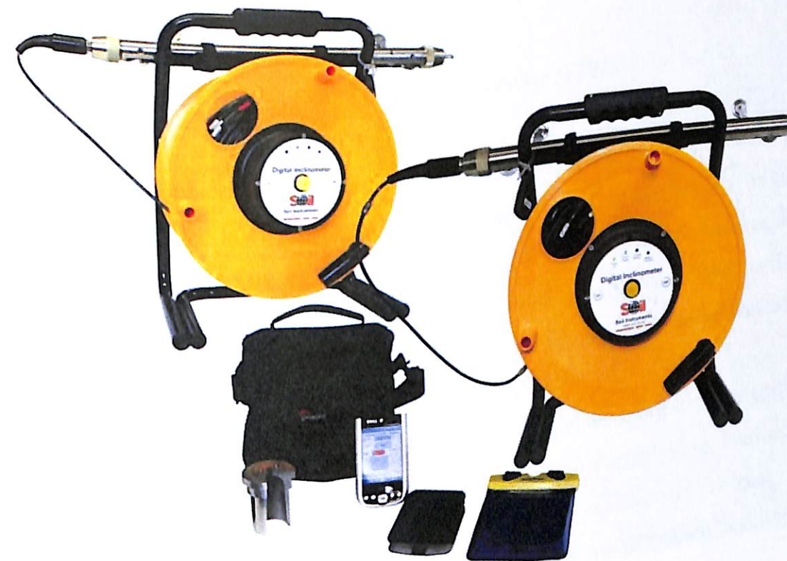
10.1. ábra: Inklinométer mérőműszer részei [VII]
