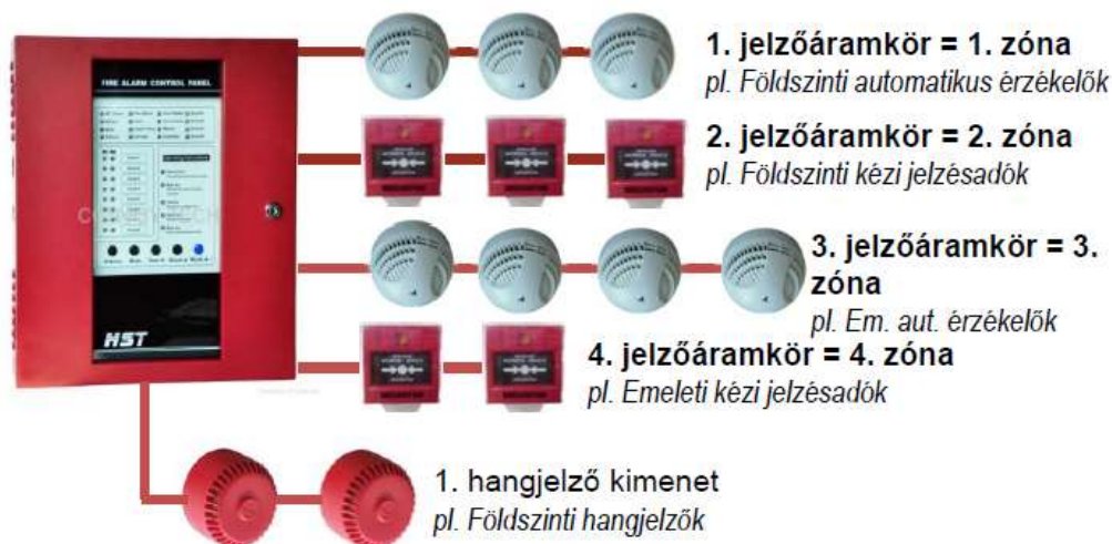
3.ábra Hagyományos hurokszelektív tűzjelző rendszerek (Forrás: Mohai Ágota, 2012)
