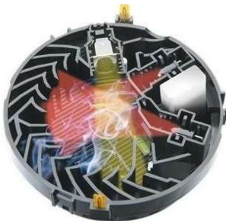
15. ábra Multiszenzor optikai, hő és CO szenzor egy házban (Forrás: ASA Technology, 2024)
