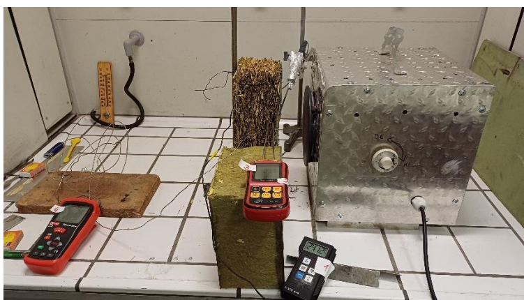
9. kép – Foszfor alapú szerrel égéskésleltetett minta vizsgálata. Saját kép
