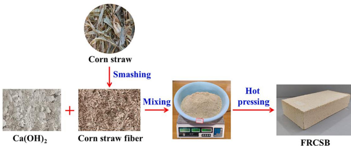
7. ábra - Tűzálló kukoricaszalma téglák előállítása. Forrás: [T. ZHANG ET AL, 2023]
