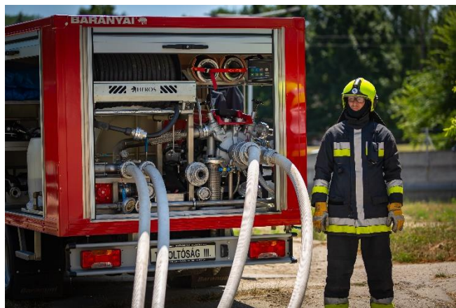
9. ábra: Toyota Dyna habbal oltó gépjármű hátsó málhatere
