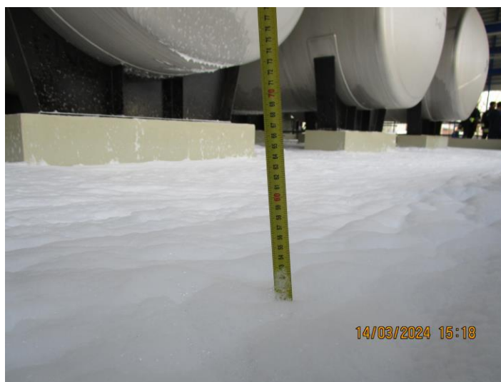
24. ábra: Habtakaró rétegvastagság mérése
