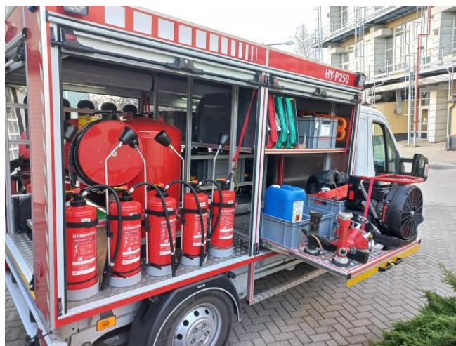
8. ábra: Citroen Jumper HY-250 porral oltó gépjármű
