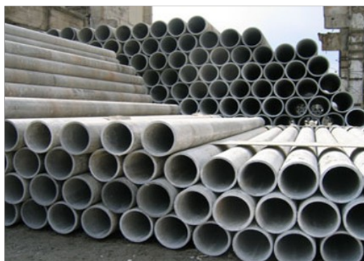
8. ábra Azbesztcement cső [8]
