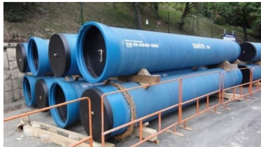
6. ábra GÖV öntöttvas cső [6]
