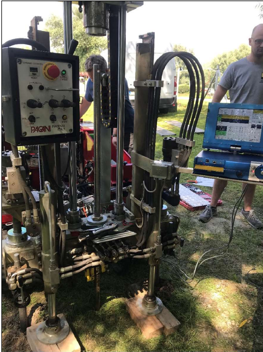
11.ábra. Statikus szondázás készítése PAGINI géppel (Forrás: saját kép)
