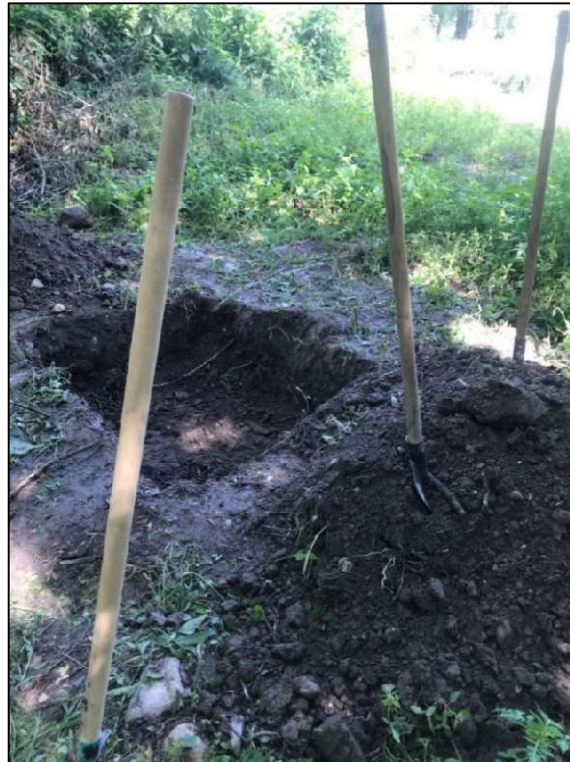
8.ábra. 0,5 méter mély kutatógödör (Forrás: saját kép)
