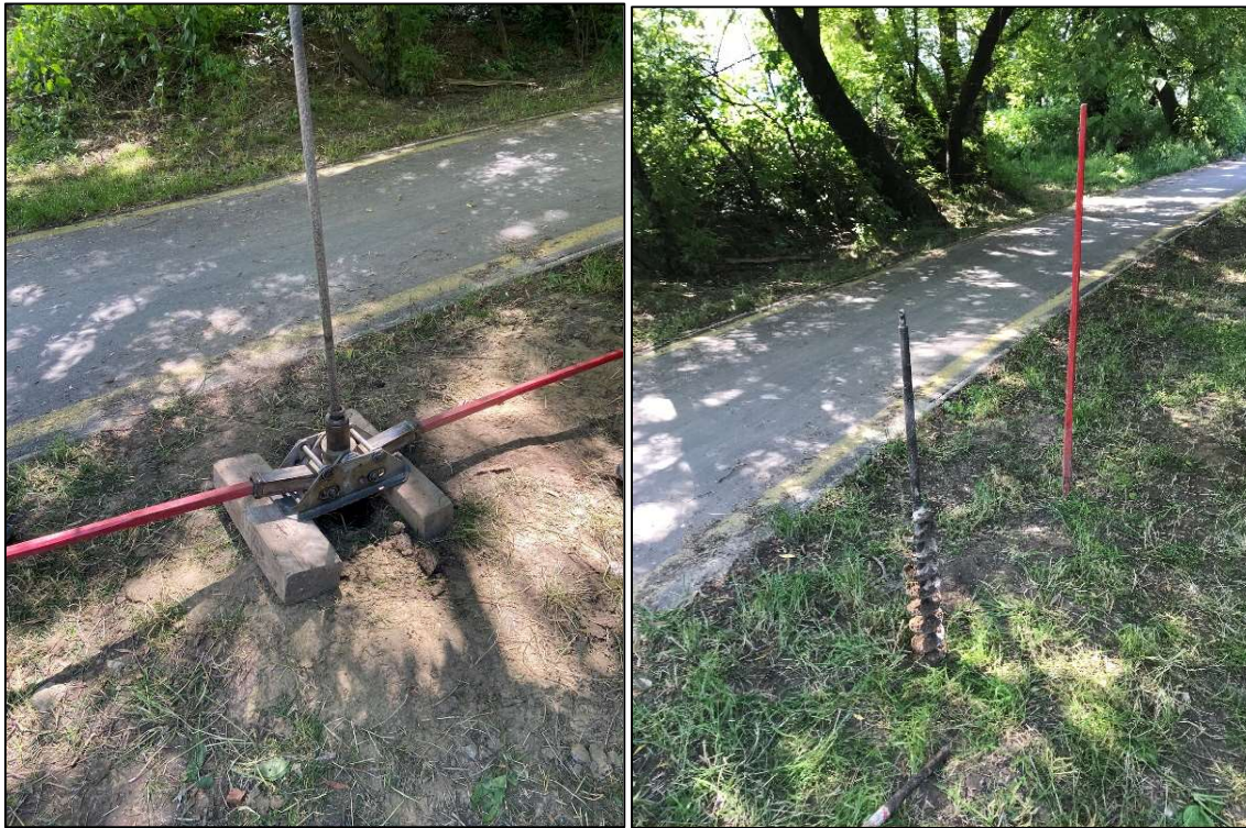
6. és 7. ábra. Borro típusú kutató spirálfúró lehajtása utáni kiszakítás, majd fúrószár toldása (Forrás: saját kép)
