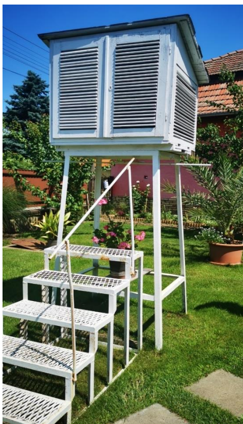
18. ábra: A 1303-as mérőállomás hőmérséklet mérő állványa a Temető utcában (saját fotó)
