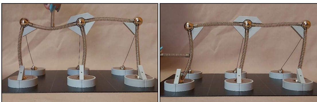
3 támaszú három fix csuklóval megtámasztott kilendülő keret
