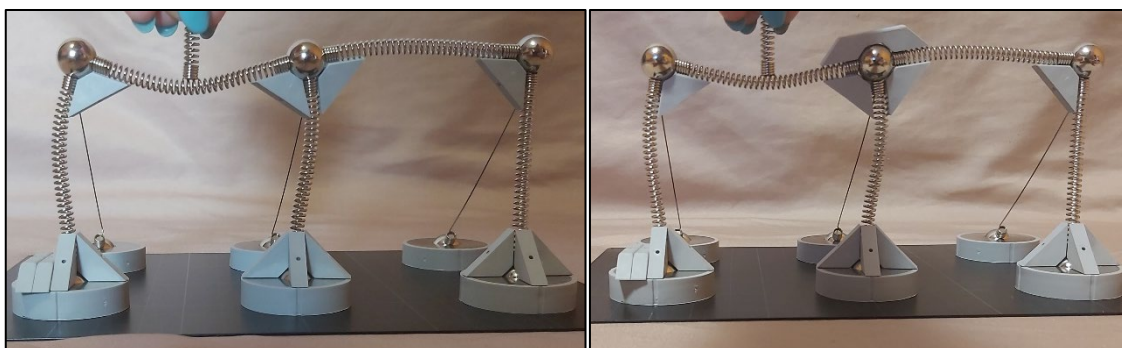
3 támaszú három befogással megtámasztott kilendülő keret
