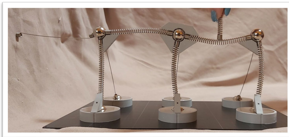
22. ábra Az oldalirányú megtámasztás szemléltetése
