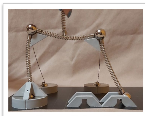
23. ábra A görgős támasz megoldása
