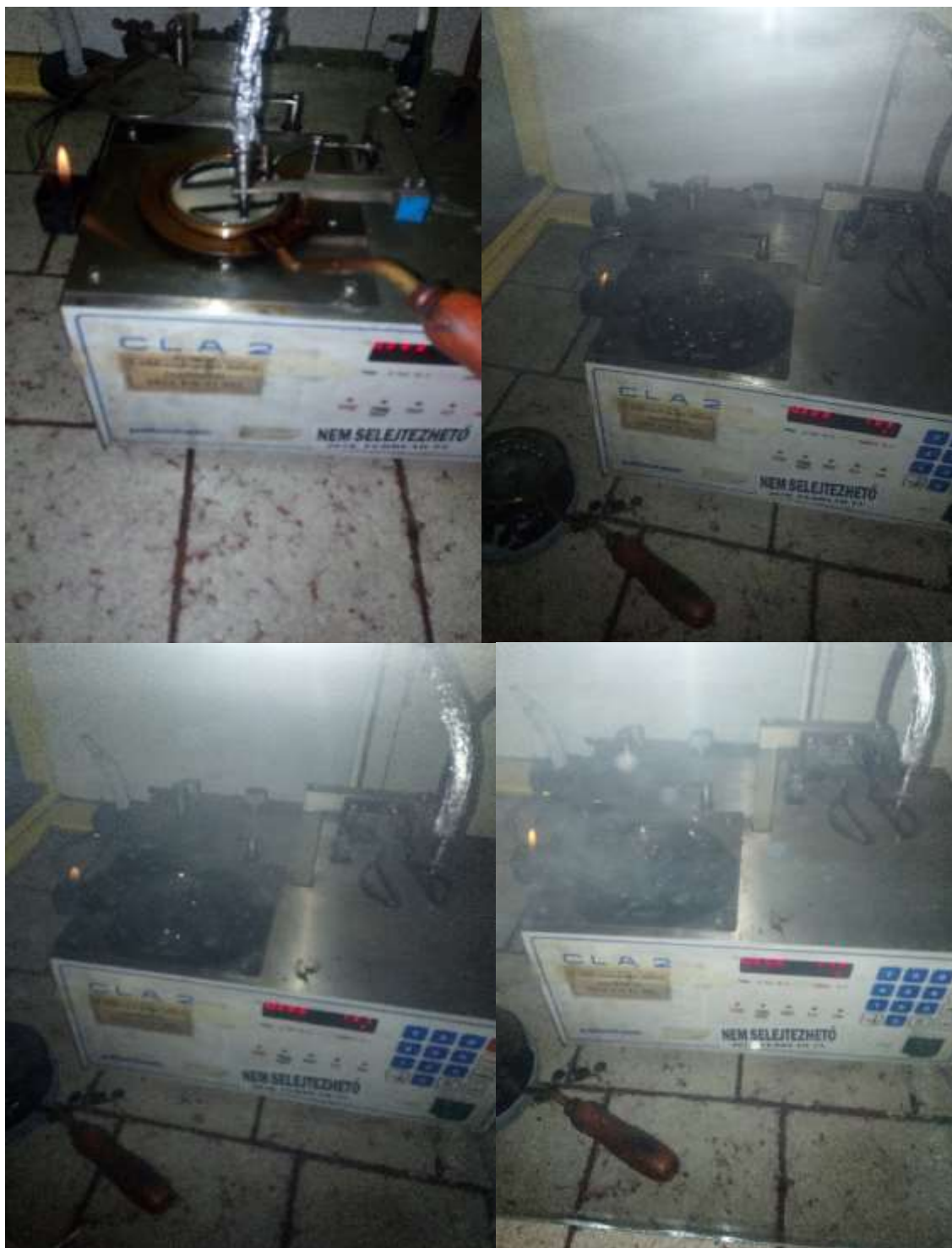
28/b ábrák nyílttéri lobbanáspont mérés forrás: saját képek
