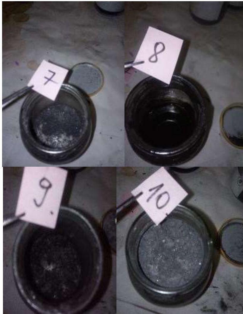
20. ábra elszívóból lerakódás és emulzió alapú hűtő-kenő folyadék minták
