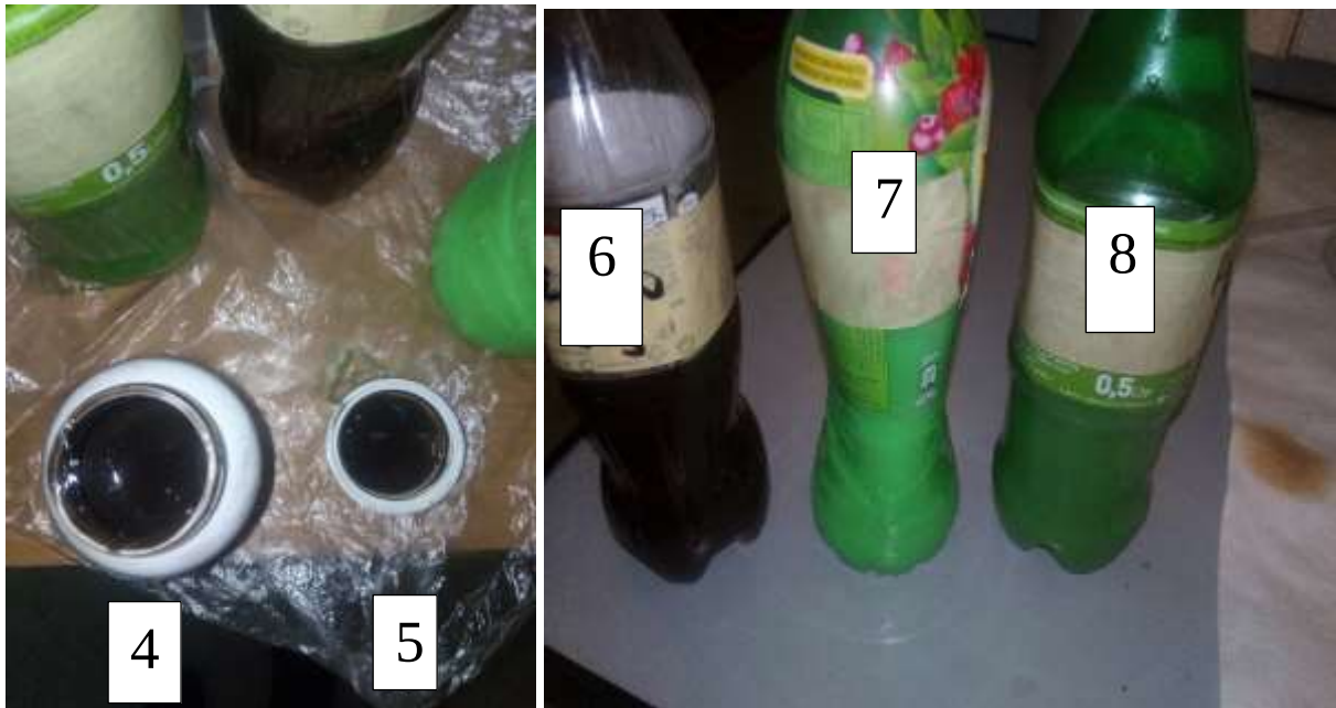
19. ábra elszívóból lerakódás és emulzió alapú hűtő-kenő folyadék minták
