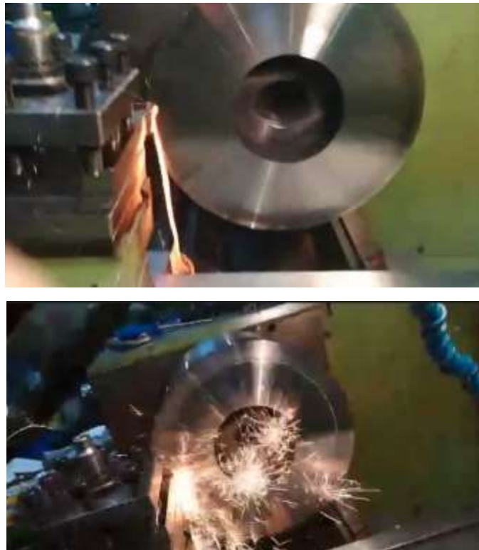
6. ábra Magnézium ötvözet forgácsolása közbeni izzó folyó forgács és szikraképződés
