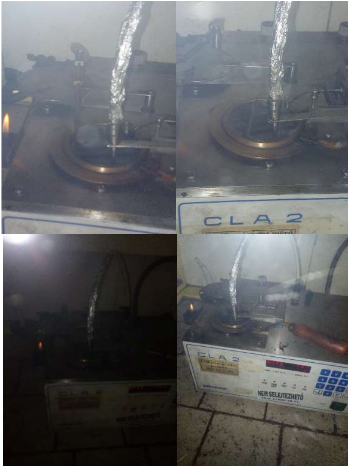
28/d ábrák nyílttéri lobbanáspont mérés forrás: saját képek
