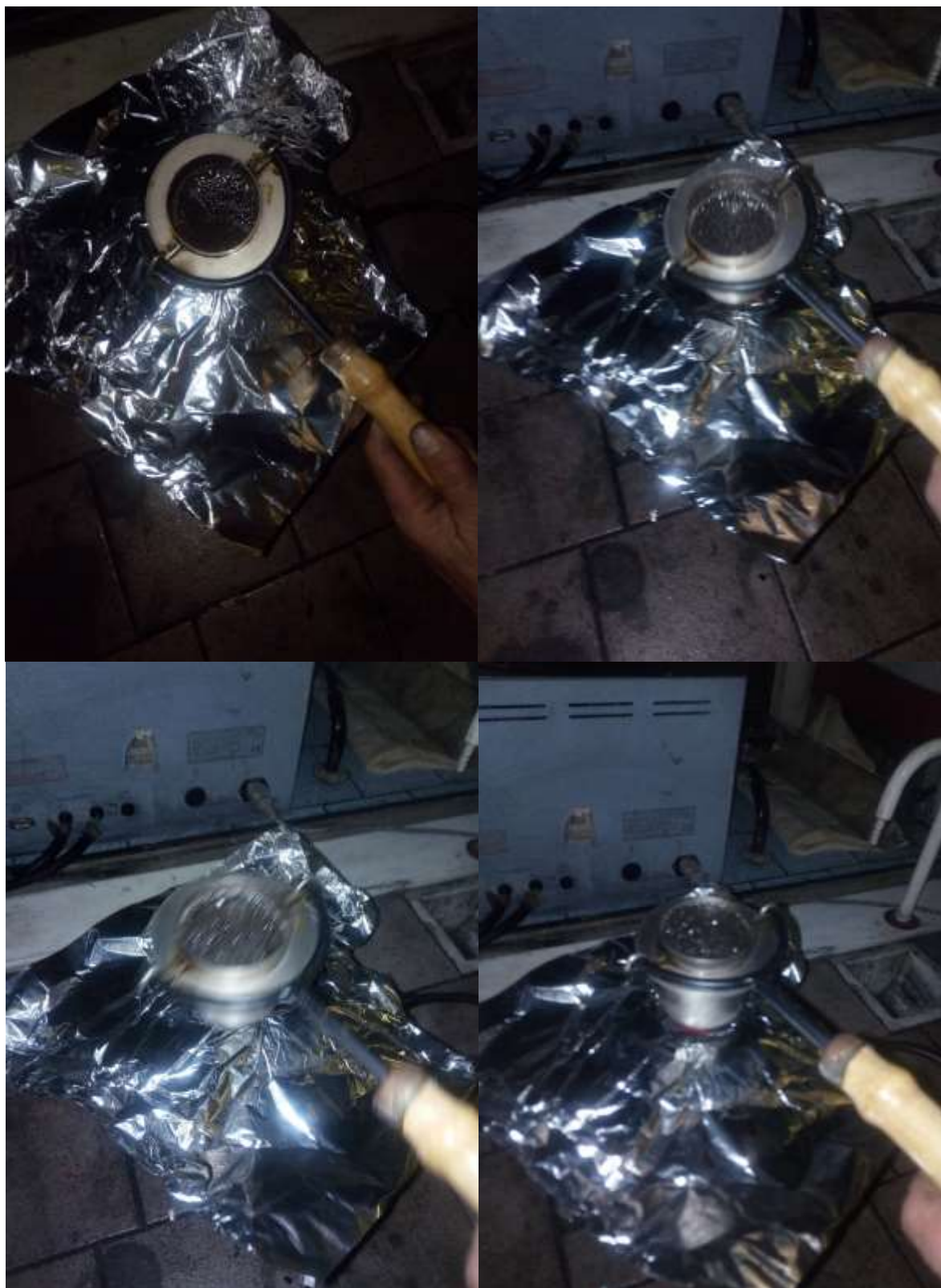
28/g ábrák nyílttéri lobbanáspont mérés forrás: saját képek
