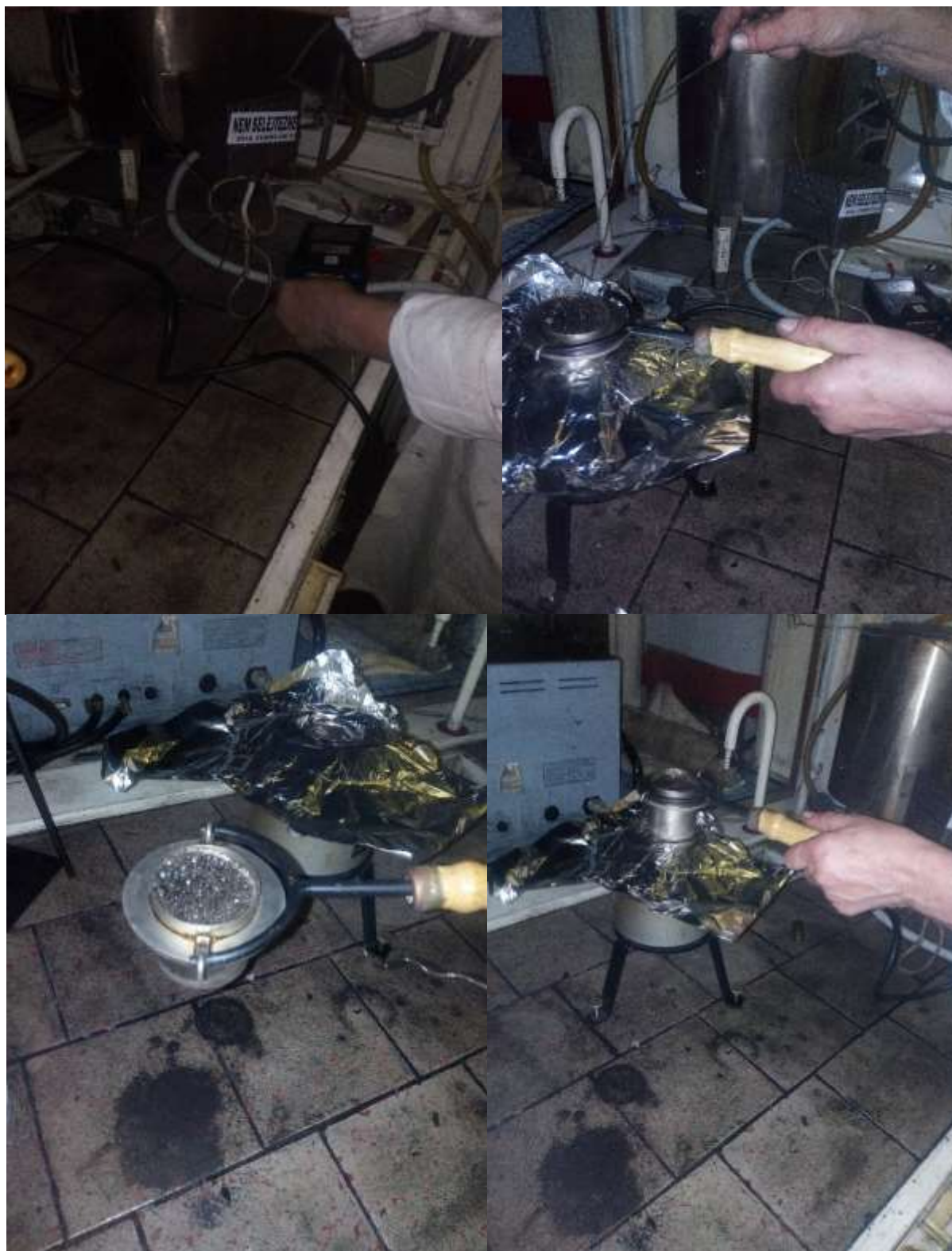
28/f ábrák nyílttéri lobbanáspont mérés forrás: saját képek
