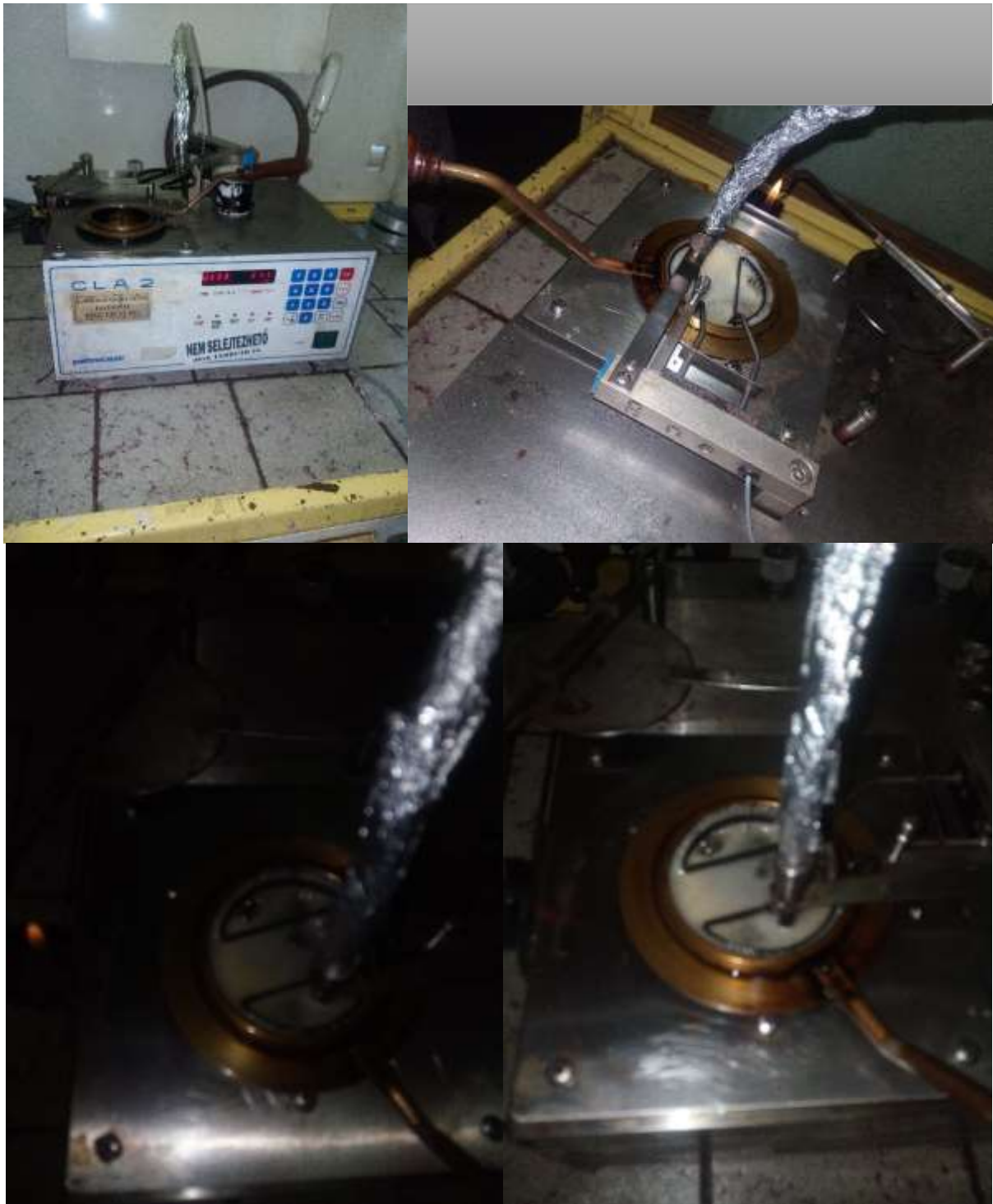
28/a ábrák nyílttéri lobbanáspont mérés forrás: saját képek
