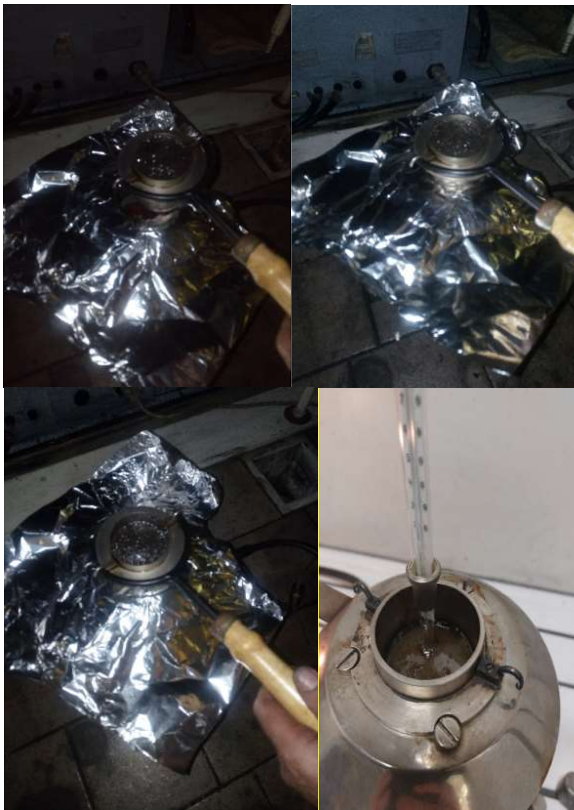
28/h ábrák nyílttéri lobbanáspont mérés forrás: saját képek
