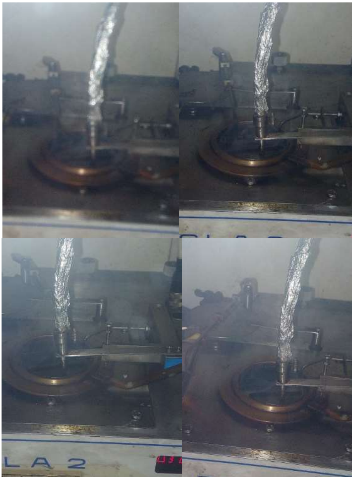
28/c ábrák nyílttéri lobbanáspont mérés forrás: saját képek
