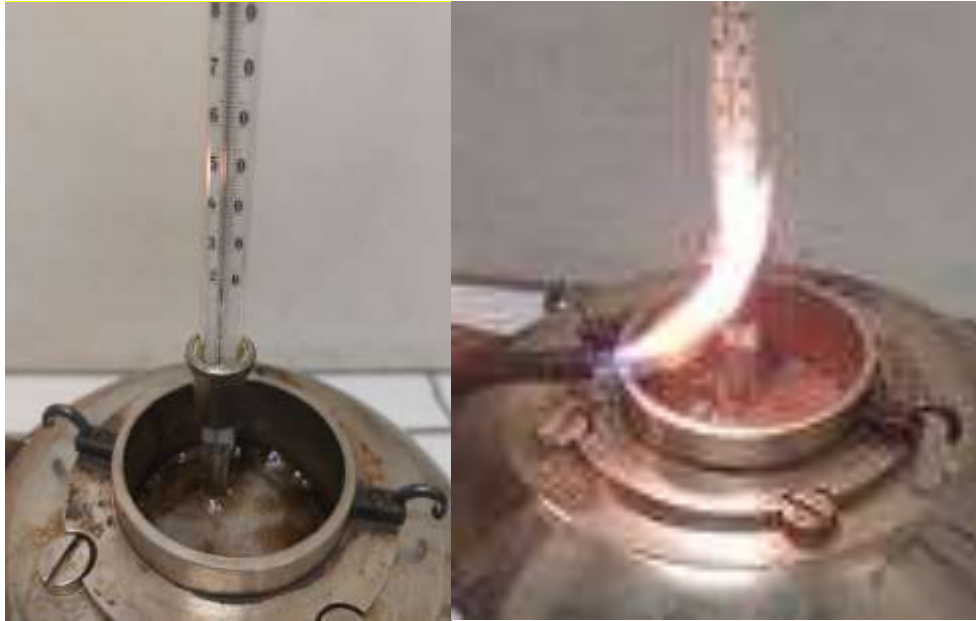
28/i ábrák nyílttéri lobbanáspont mérés forrás: saját képek
