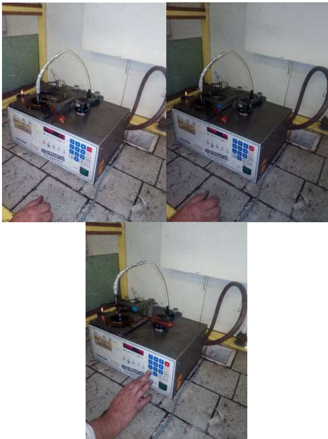
28/e ábrák nyílttéri lobbanáspont mérés forrás: saját képek
