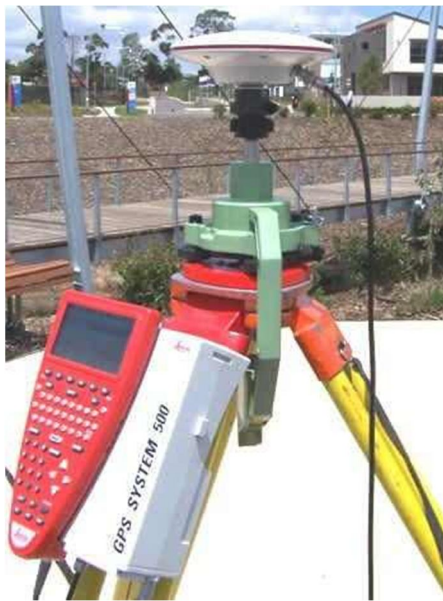
4.2. ábra Leica System 500 GPS vevő (forrás:
