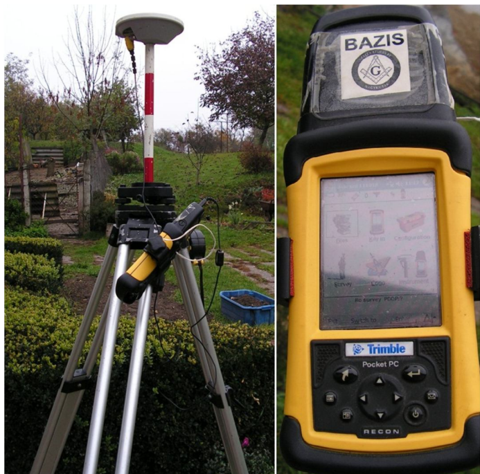
4.1. ábra Saját Trimble R3 GPS bázisállomás
