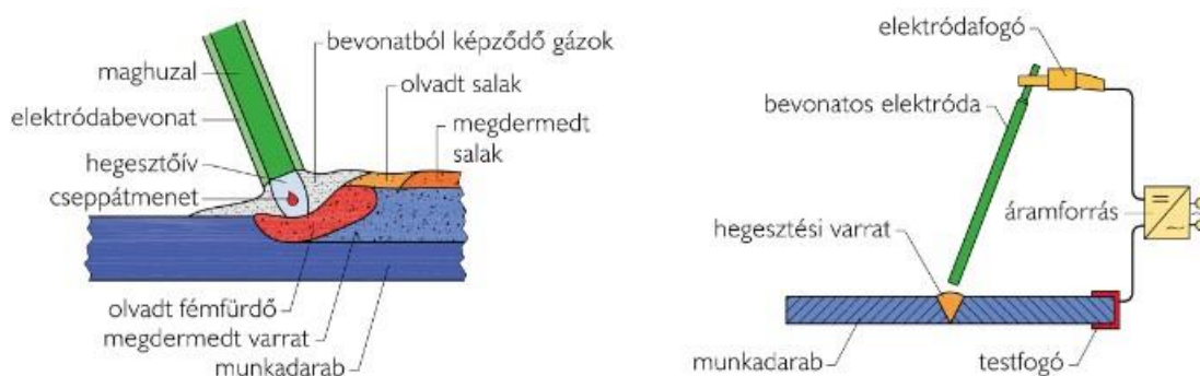
3. ábra. Kézi ívhegesztés hosszmetsete (bal) és a kézi ívhegesztés elvi vázlatá (jobb)
