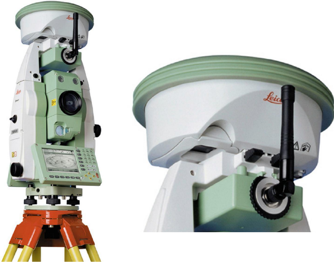
11. ábra. A Leica TCA1205, mint GNSS-mérőállomás.
