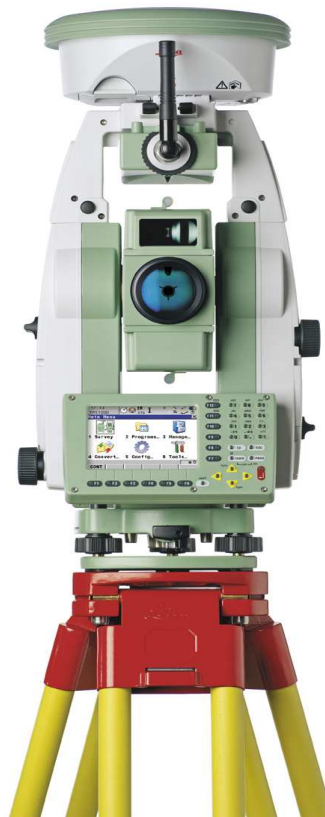
4. ábra: a Leica TCA 1205-ös mérőállomás GNSS vevő berendezéssel
