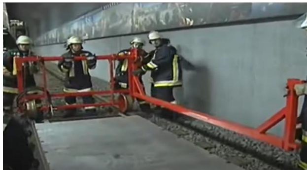
22. kép A Rail-Kit modulokból történő összeállítása (forrás: LuF GmbH https://www.youtube.com/watch?v=FZ1sQU0oU-s )
