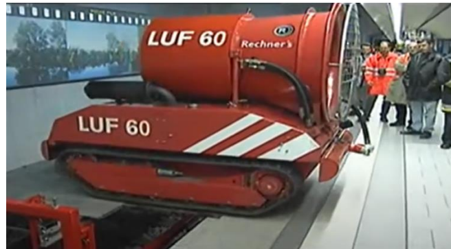
23. kép A LuF 60 a metróállomás peronjáról ráhajt a mobil elemekből épített Rail-Kitre (forrás: LuF GmbH https://www.youtube.com/watch?v=FZ1sQU0oU-s )
