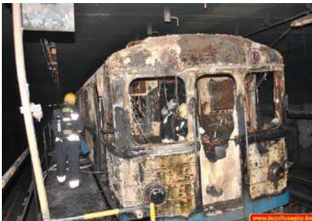
9. kép Kiégett metrószerelvény (forrás: FKI esettanulmány)
