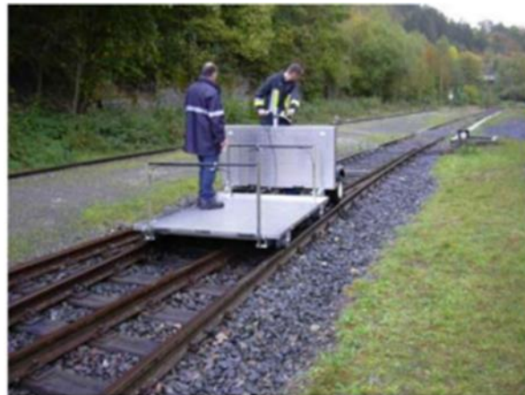
19. kép A sínre telepített komplett elektromos kiskocsi működés közben
