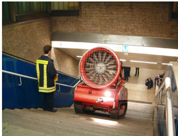
20. kép A LuF 60 robot metró lépcsőn távirányítással történő vezetésének bemutatása (forrás: LuF GmbH)
