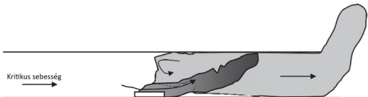
6. ábra A 3. csoportra jellemző füst rétegződést bemutató vázlat 3 m/s áramlási sebességnél nagyobb, kritikus áramlási sebességnél ( u_c ) [INGASON ET AL, 2015]
