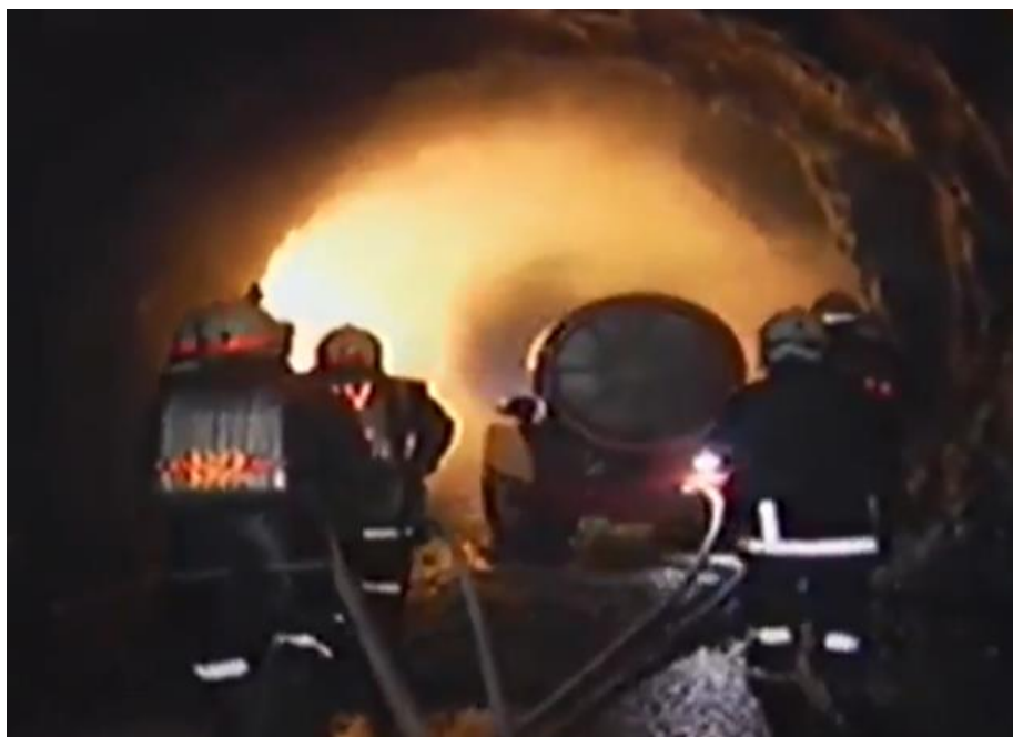
26. kép Alagúttűz oltása LuF 60 tűzoltó robottal
