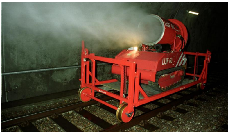
25. kép A Rail-Kiten lévő LuF 60 metróalagútban működésbehozott vízködoltóval (forrás: LuF GmbH https://www.youtube.com/watch?v=FZ1sQU0oU-s )
