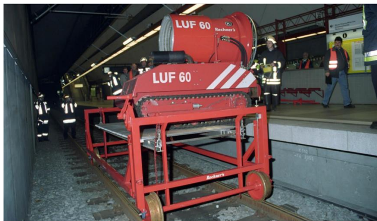
24. kép A LuF 60 a Rail-Kiten történt málházás után (forrás: LuF GmbH https://www.youtube.com/watch?v=FZ1sQU0oU-s )
