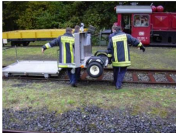
18. kép A kocsi elektromos egysége négy tűzoltó által történő sínre helyezése
