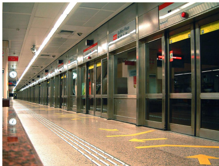
7. kép Példa a peron fal ajtók (platform screen doors PSD) felszerelésére (forrás: Wikipédia https://en.wikipedia.org/wiki/Platform_screen_doors )
