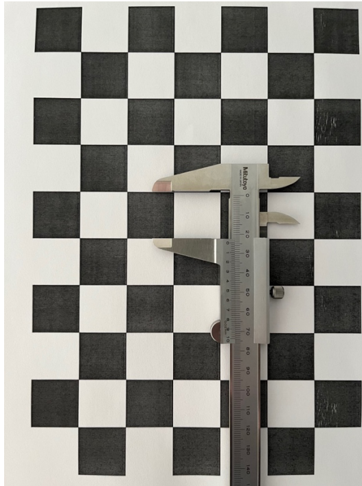
6.14 ábra A kinyomtatott OpenCV kamera kalibrációs minta mérése
