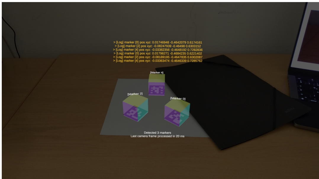
6.20 ábra HoloLens2CVUnity program futás közben, a letakart markerekről lekerül a virtuális kocka
