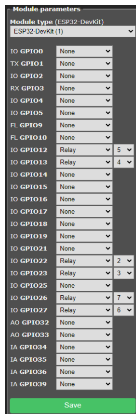
12. ábra Lámpa portok konfigurációja [Saját kép]
