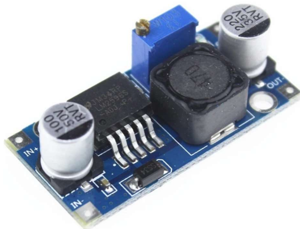
17. ábra LM2596 lefokozó DC-DC átalakító
