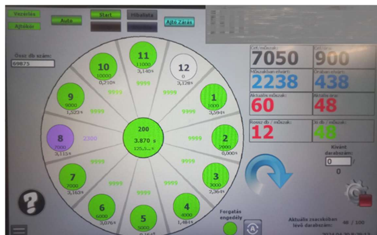
8. ábra A 8-as állomás lila színe jelzi, hogy a gép várakozik. Más hibajelzés nincs a kijelzőn.
