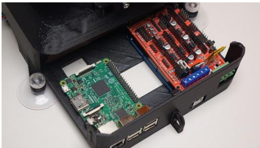
12. ábra A Raspberry Pi tábla (bal oldalon), az Arduino(a jobb oldalon) [25]
