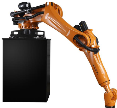
9. ábra Modern 6 tengelyes robot [20]
