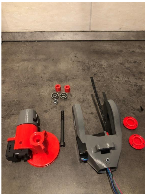
21. ábra Persely a tengelyekhez (kép teteje), takaró (jobb oldal)
