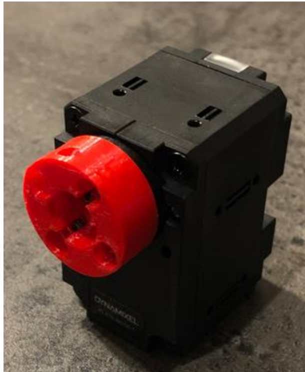
17. ábra Az első kinyomtatott alkatrész, az egyik motor tengelykapcsolójának háza
